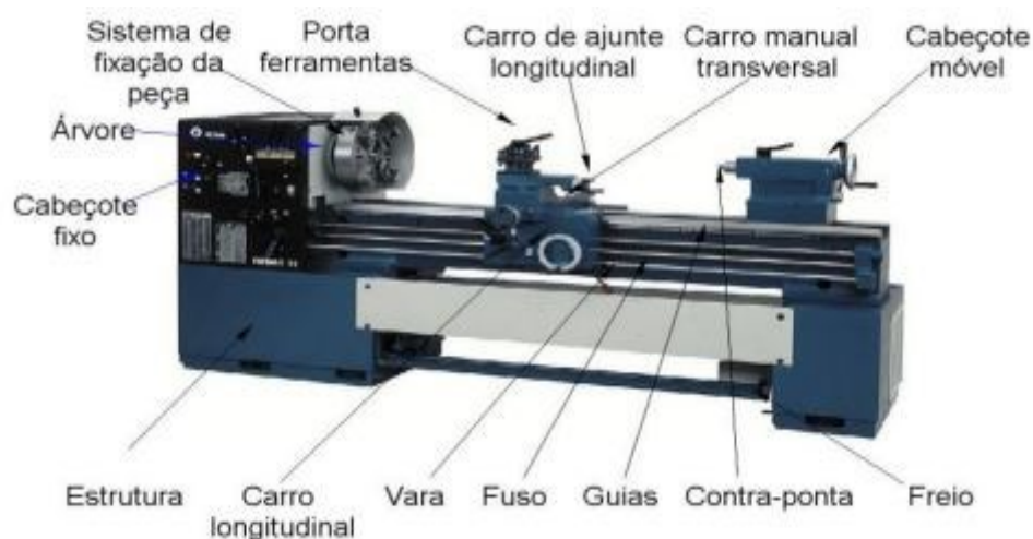
Figura 1 – Principais conjuntos de um torno convencional.
