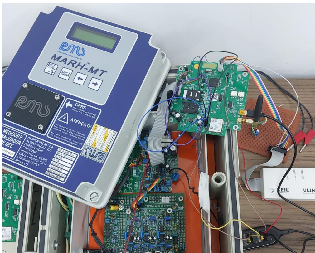
Figura 18 – Hardware implementado para o desenvolvimento do firmware
