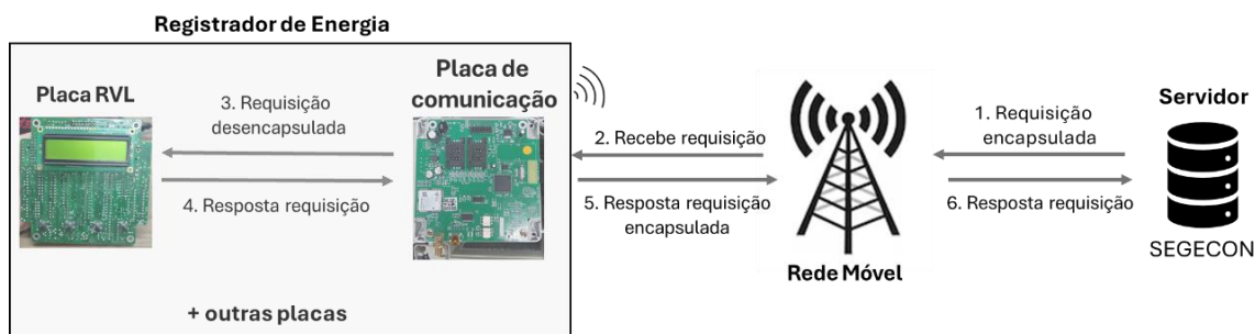
Figura 1 – Diagrama da comunicação entre o SEGECON e o registrador de energia
