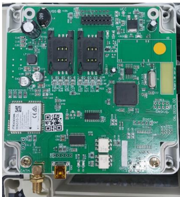
Figura 4 – Placa de comunicação
