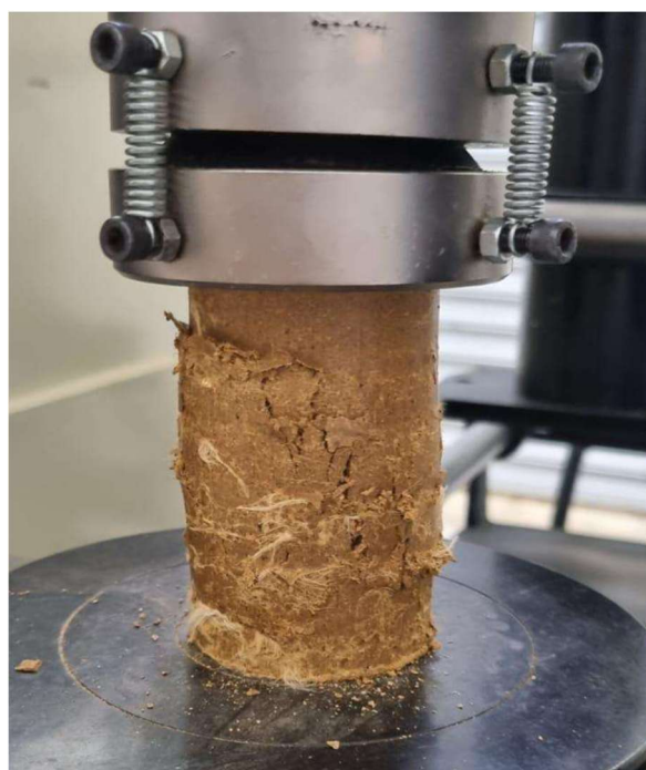
Figura 11 – Ensaio de compressão simples
