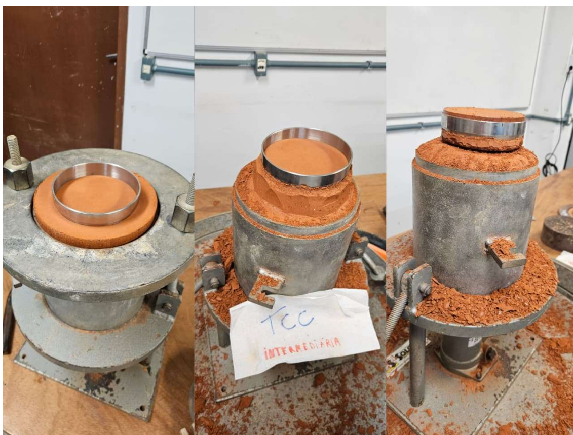
Figura 36 – Cravação do anel de compressão confinada
