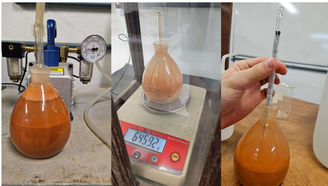
Figura 29 – Etapas do Ensaio de densidade real dos grãos
