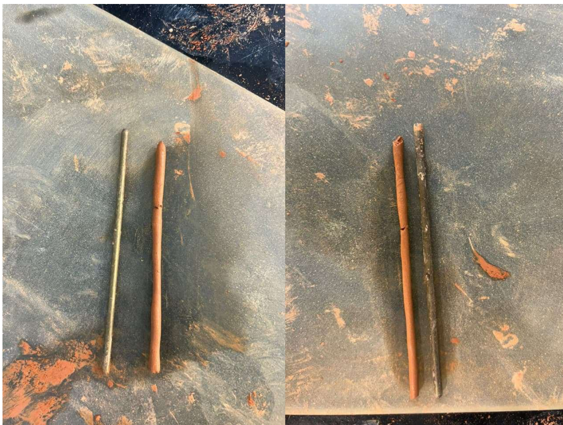
Figura 31 – Ensaio limite de plasticidade
