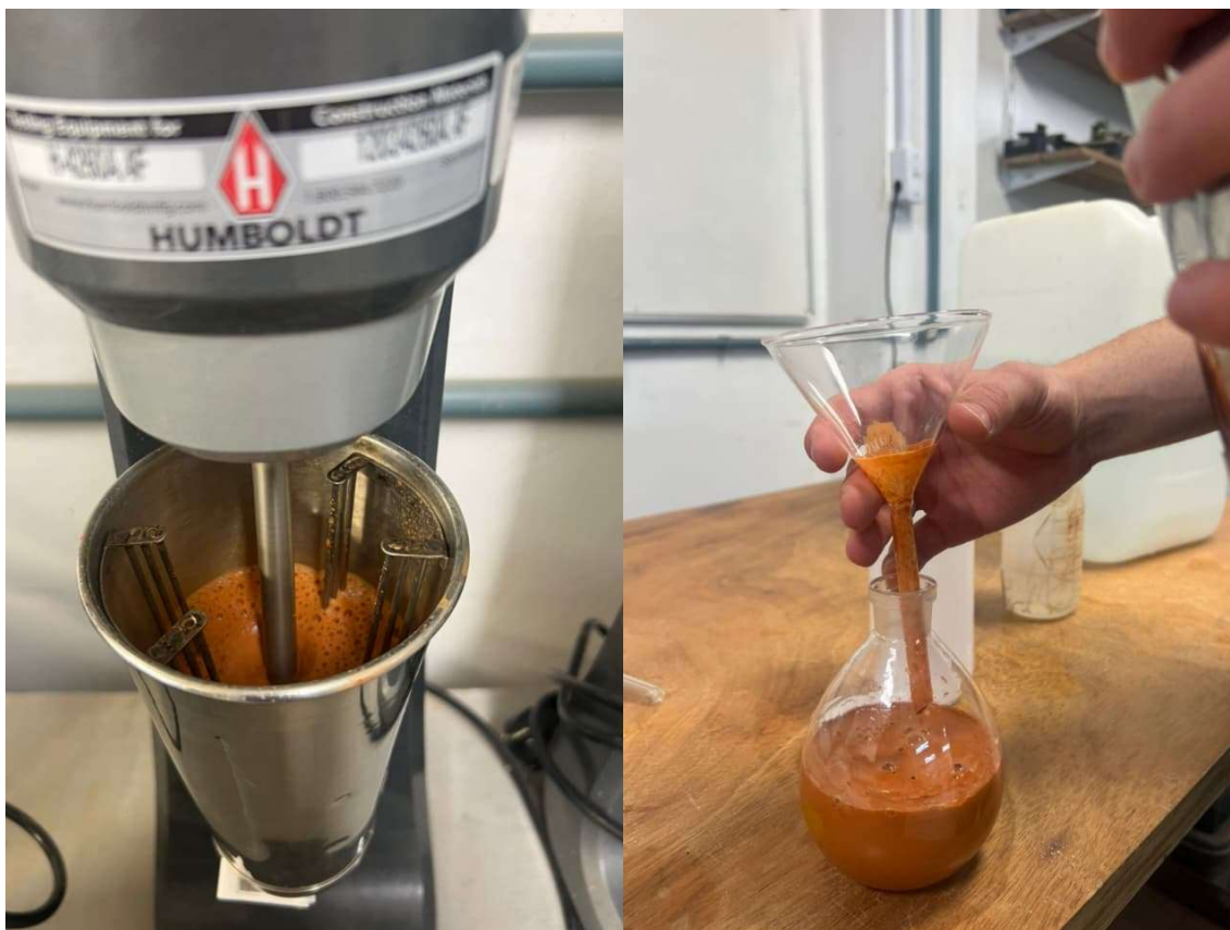
Figura 28 - Etapas do Ensaio de densidade real dos grãos
