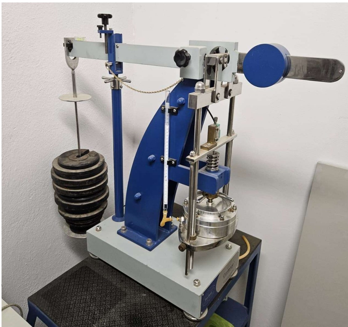
Figura 38 - Equipamento do ensaio de compressão confinada
