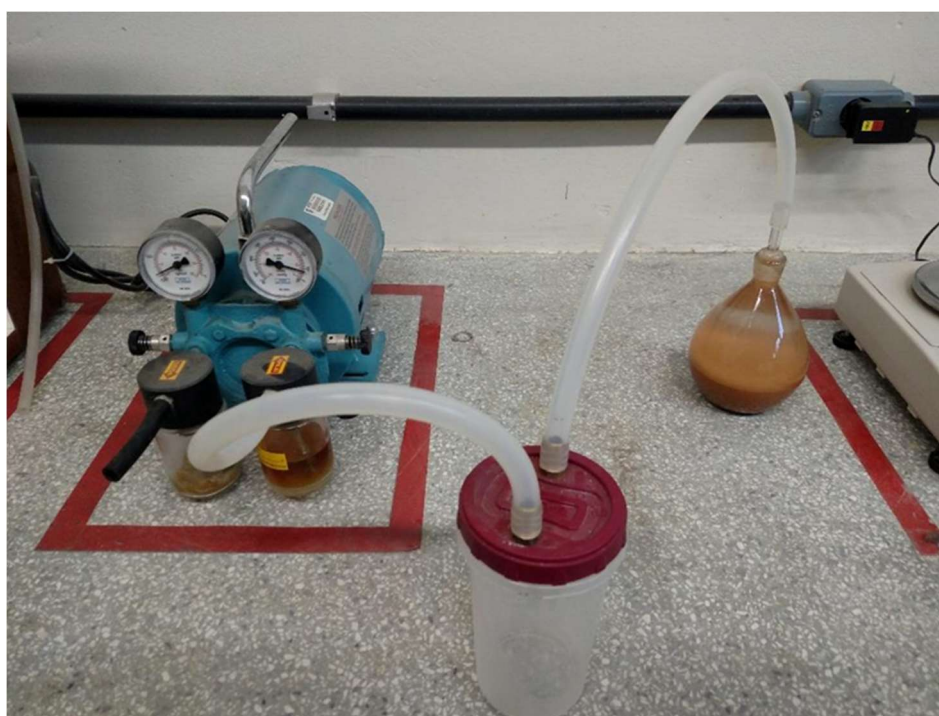
Figura 6 –Ensaio com picnômetro em andamento
