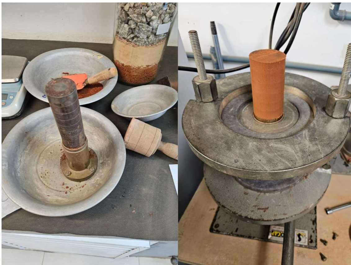
Figura 33 – Compactação no cilindro Harvard
