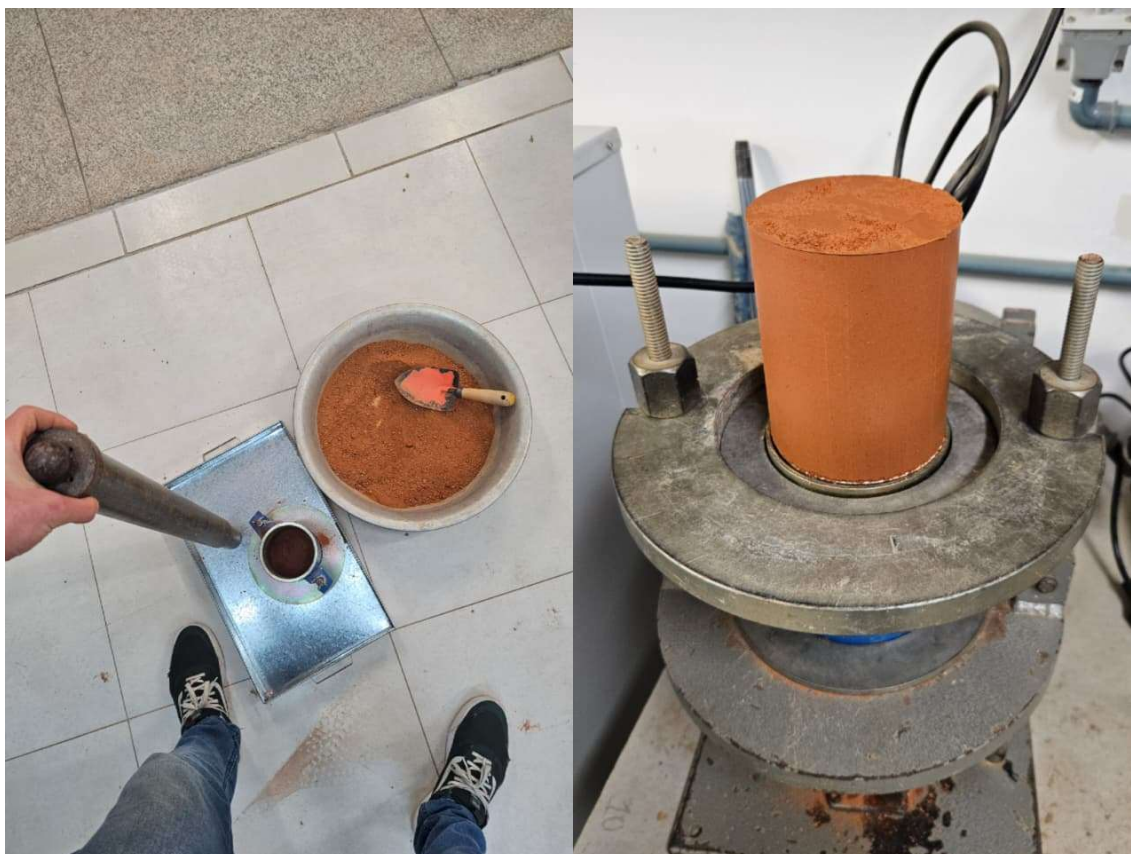
Figura 32 – Etapas do ensaio de compactação
