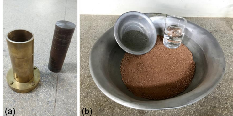
Figura 23 - (a) Molde cilíndrico (b) Materiais para confecção do CP
