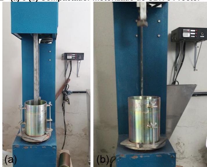
Figura 21 - (a) e (b) Compactador motorizado de CBR e Proctor - Contenco
