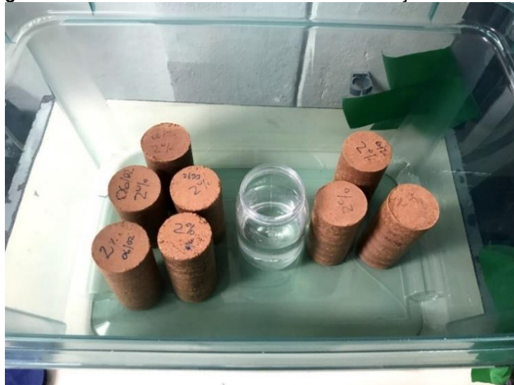
Figura 25 - Processo de cura dos CPs com adição de cimento
