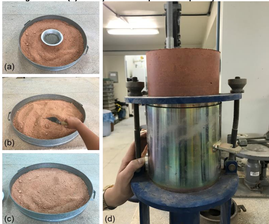
Figura 22 - (a) Solo e cimento para a mistura (b) Mistura manual da amostra (c) Amostra homogeneizada (d) Extração do CP após a compactação do material
