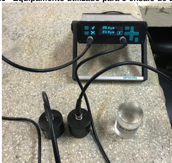
Figura 26 - Equipamento utilizado para o ensaio de ultrassom
