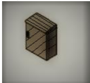
Figura 25: Quadro Parcial de Luz e Força
