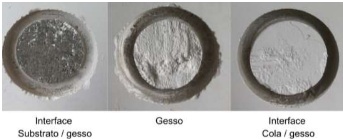
Figura 08: Tipos de rupturas dos ensaios.
