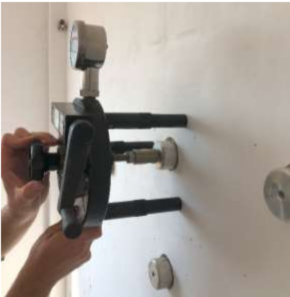
Figura 05: Equipamento de arrancamento.
