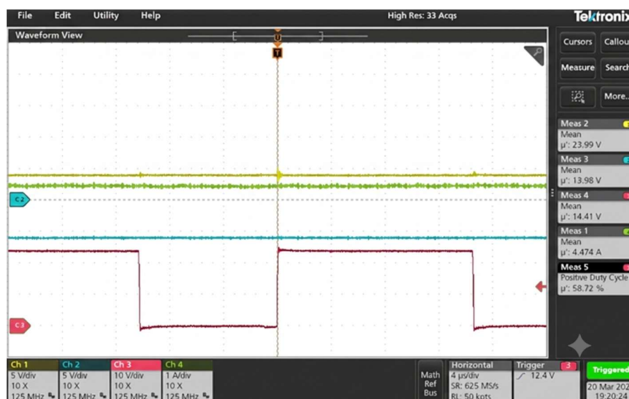
Figura 61 – Formas de onda modo buck: tensão do Barramento A (CH1, 5 V/div), tensão do Barramento B (CH2, 5 V/div), tensão sobre o diodo de S2 (CH3, 10 V/div) e, corrente na carga (CH4, 1 A/div)
