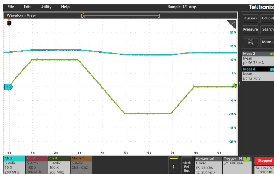
Figura 71 – Resultado obtido para a execução referências em rampas pelo sistema projetado. Corrente na bateria (CH4, 5 A/div) e tensão na bateria (CH2, 5 V/div)
