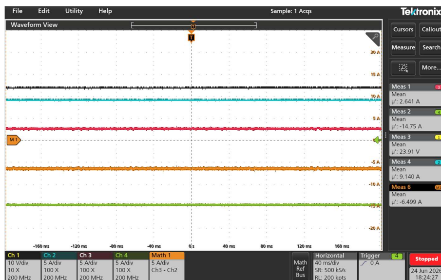
Figura 66 – Forma de onda da operação no modo boost com utilização de baterias como carga; CH1 tensão de entrada (10 V/div), CH2 tensão de saída (10 V/div), CH3 corrente na fonte (5 A/div) e, CH4 corrente na bateria (5 A/div)
