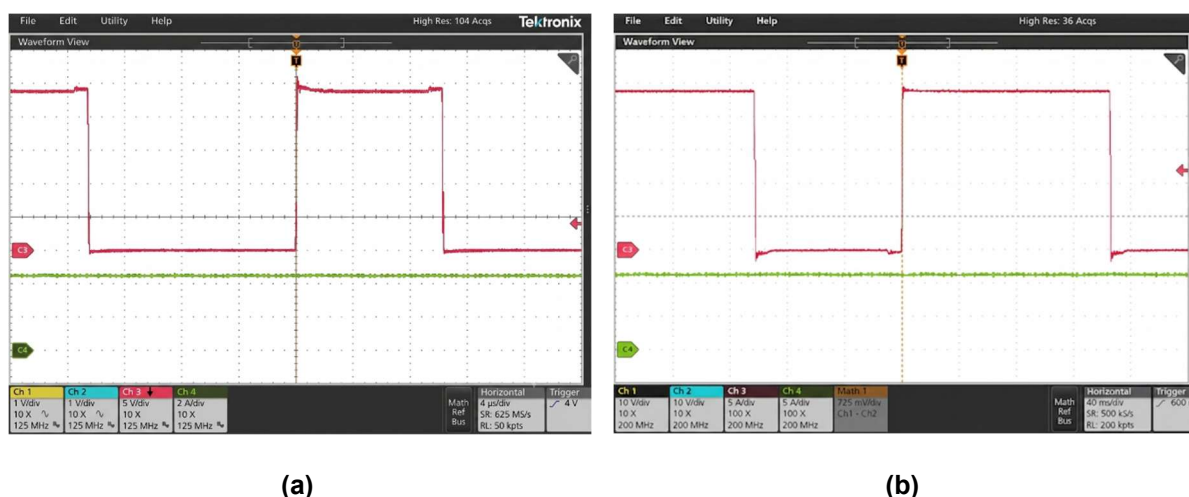
Figura 62 – Corrente na carga (CH4, 2 A/div) e tensões sobre os semicondutores: a) tensão sobre o MOSFET S1 (CH3, 5 V/div) e; b) tensão sobre o MOSFET S2 (CH3, 5 V/div)
