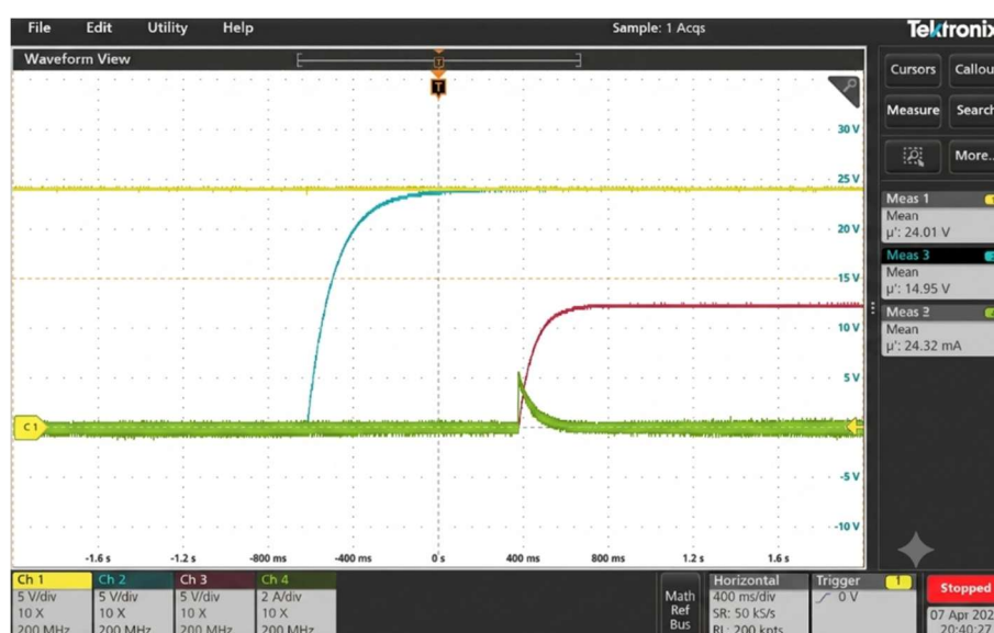
Figura 74 – Medição da corrente de inrush no Barramento B. Corrente na bateria (CH4, 2 A/div); Tensão no Barramento B (CH3, 5 V/div); Tensão no Barramento A (CH2, 5 V/div); Tensão de alimentação do sistema (CH1, 5 V/div)
