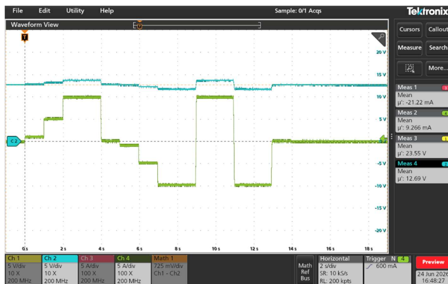
Figura 69 – Resultado obtido para um perfil de corrente aleatório; corrente na bateria (CH4, 5 A/div) e tensão na bateria (CH2, 5 V/div)
