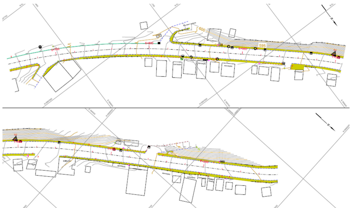
Figura 20 - Ilustração do levantamento topográfico planialtimétrico cadastral
