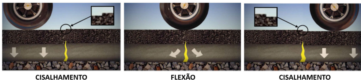
Figura 14 - Solicitações cisalhantes e de flexão no revestimento asfáltico
