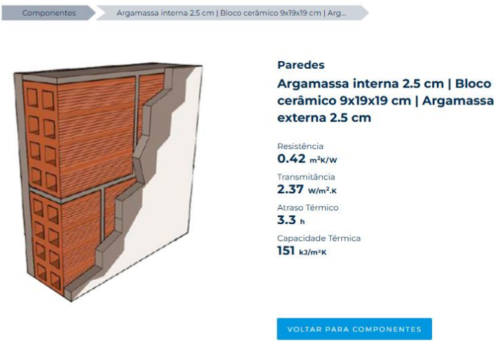
Figura 15 - Parede correspondente ao sistema construtivo convencional da edificação.
