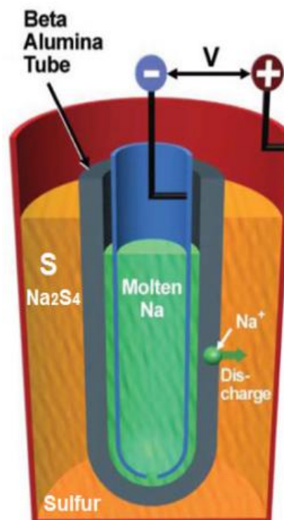
Figura 5 - Processo eletroquímico de uma bateria de Sódio-Enxofre.
