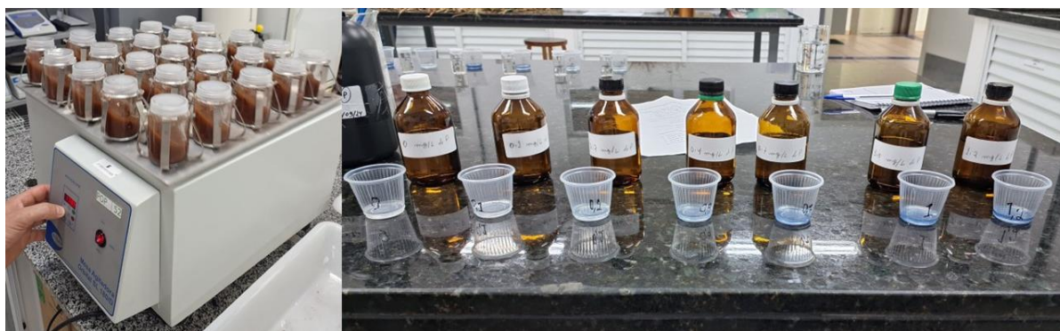
FIGURA 3 – Agitação de amostras para determinações de nutrientes e curva de P para calibração de espectrômetro para análise de P.
