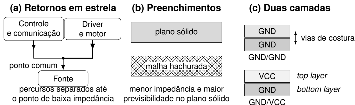
Figura 1 – Conceitos de distribuição de terra em placas de circuito impresso
