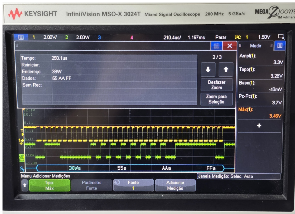
Figura 23 – Pacotes I 2 C observados durante a validação da IHM
