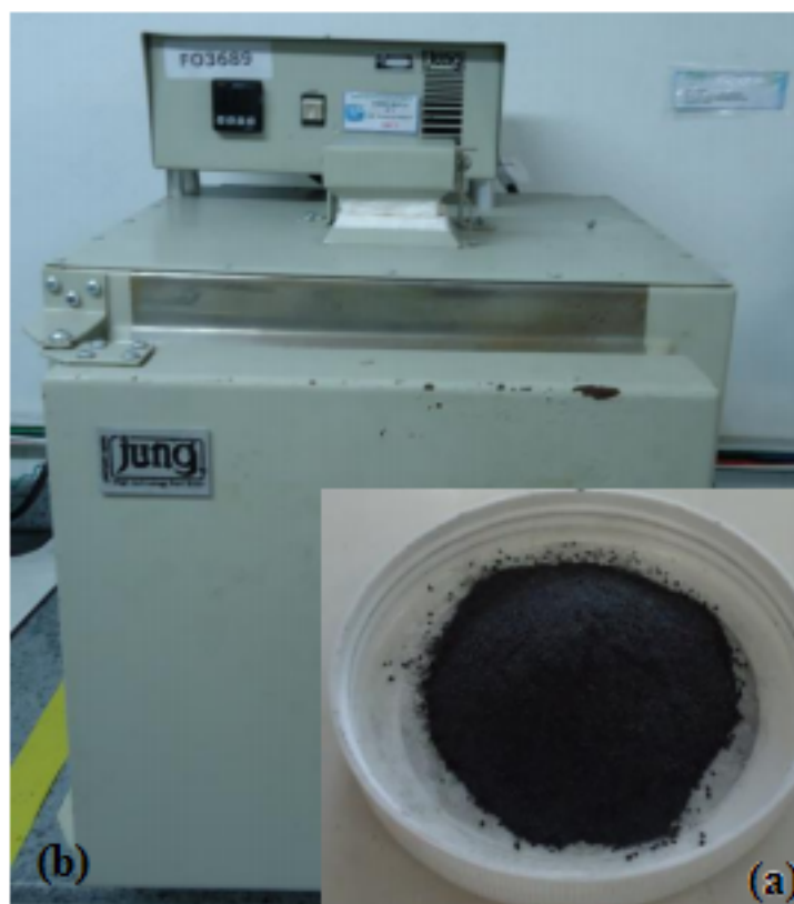
Figura 14: Demonstração do forno mufla e do pó Ekabor®
