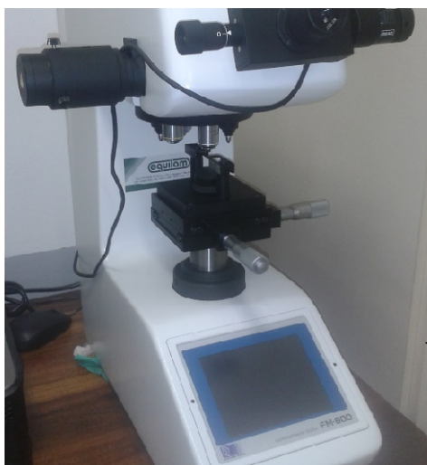
Figura 16: Microdurômetro utilizado para a análise de dureza das amostras
