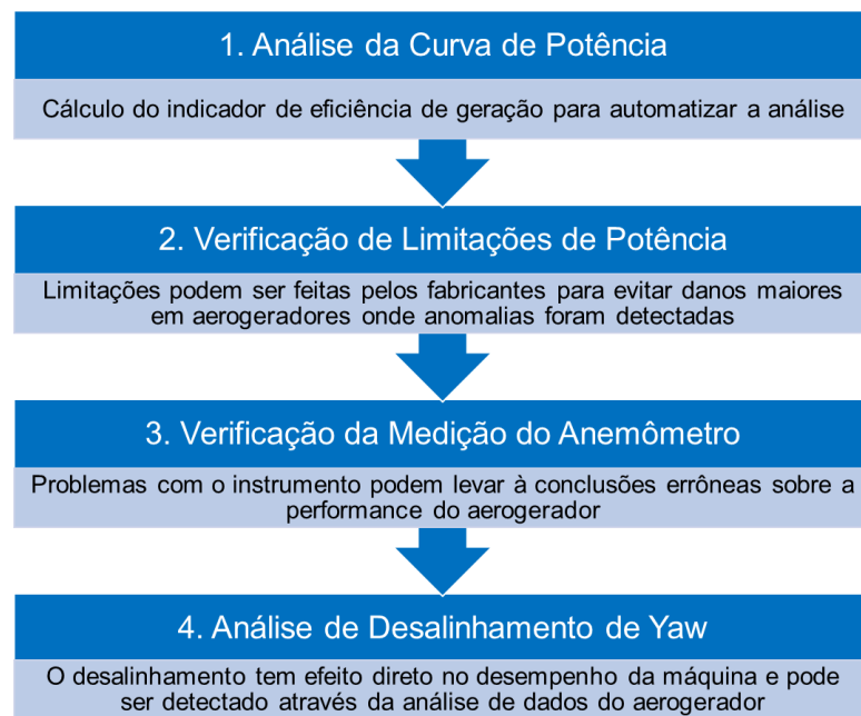
Figura 10: Etapas para análise de desempenho de aerogeradores e detecção de máquinas com problemas de performance e possíveis razões.
