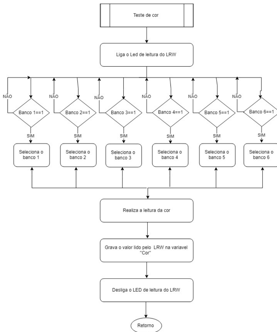
Figura 69- Fluxograma do subprograma Teste de cor.
