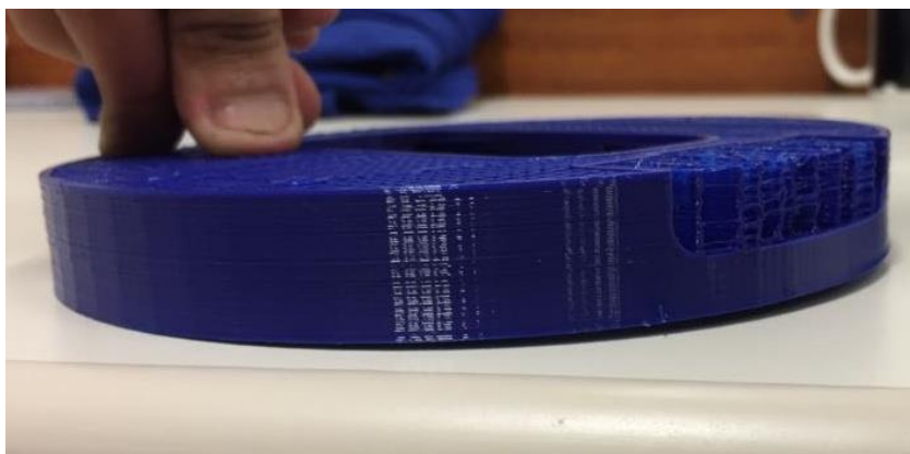
Figura 42 - Peça com empenamento
