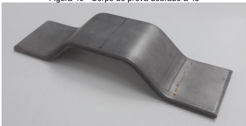
Figura 40 - Corpo de prova dobrado a 45°
