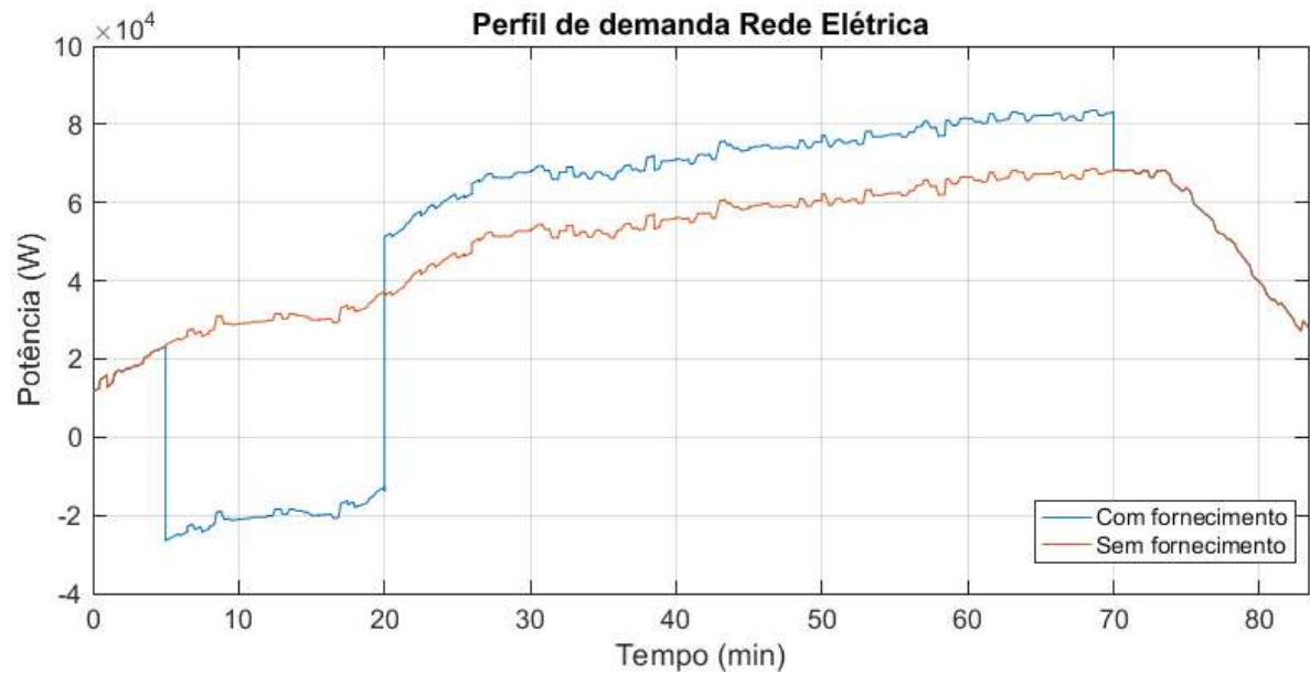
Figura 71 – Perfil de demanda do data center da perspectiva da rede elétrica nas simulações com e sem fornecimento de energia pelo UPS.
