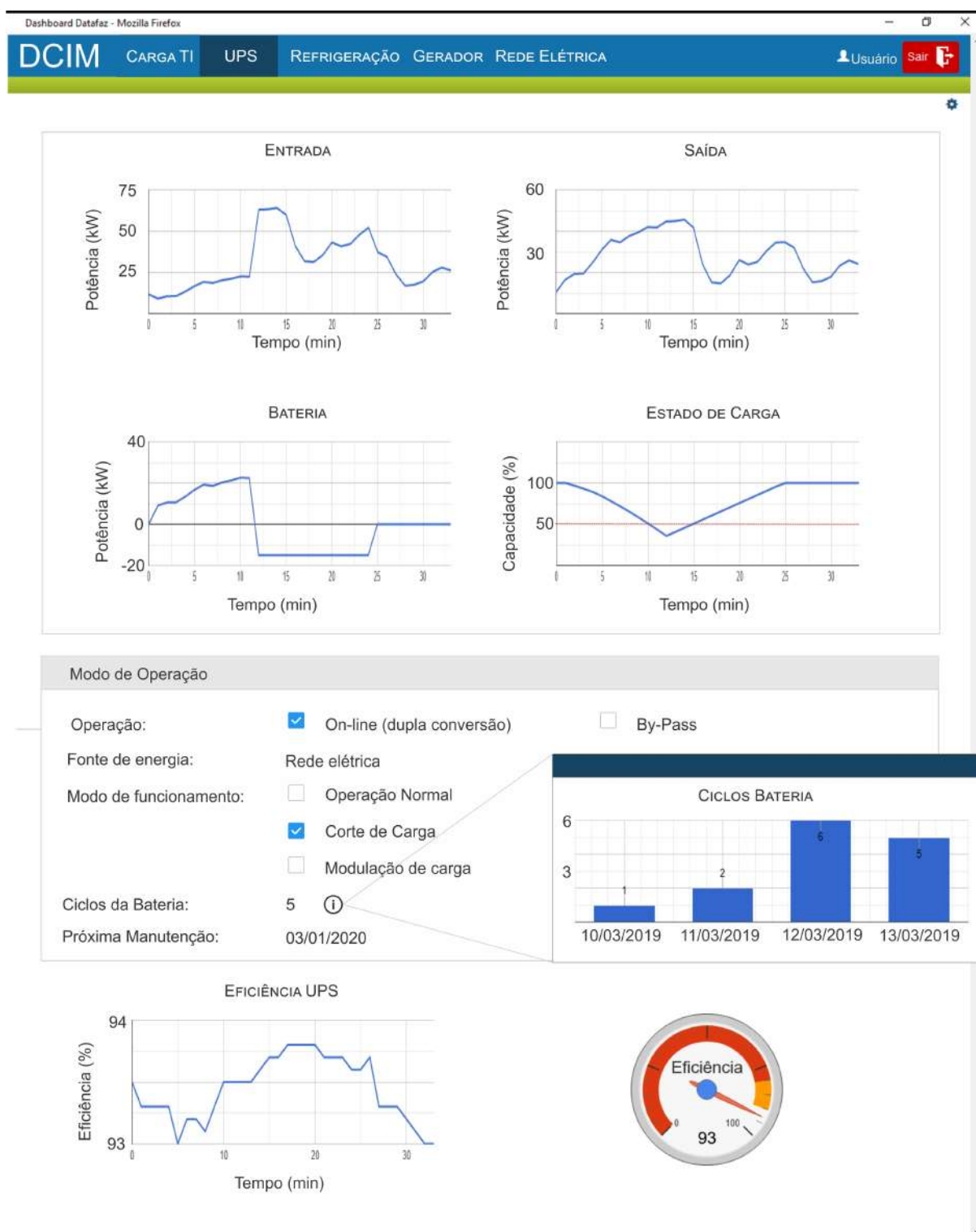
Figura 82 – Painel de monitoramento e controle de UPS que será inserido na plataforma DCIM.
