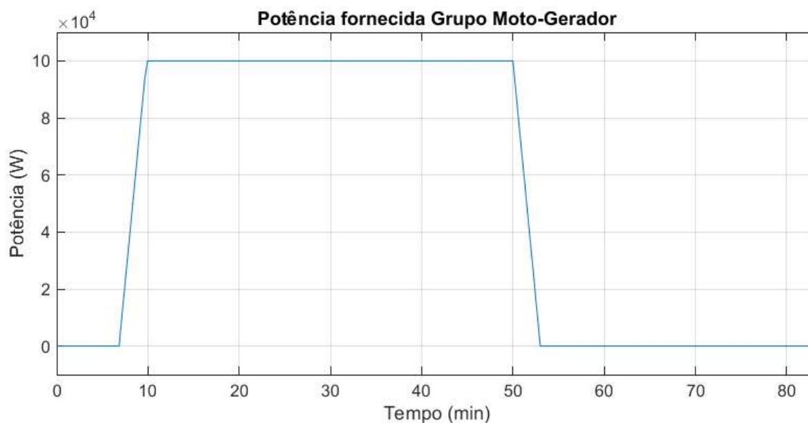
Figura 77 – Perfil da potência do grupo moto gerador durante o fornecimento de energia.
