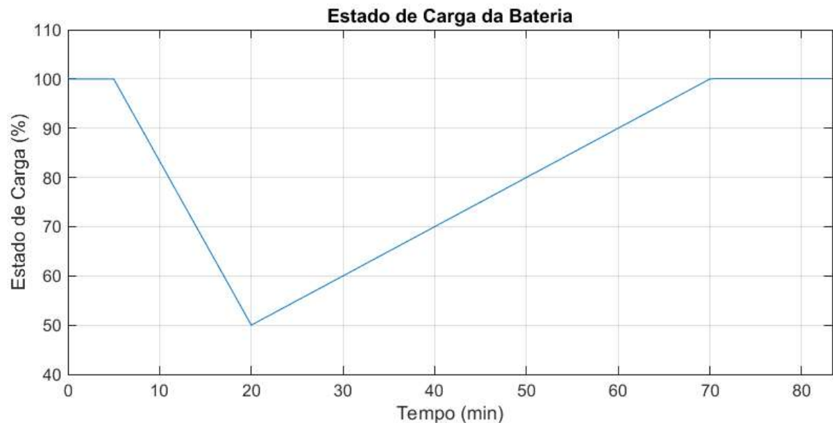
Figura 72 – Estado de carga das baterias durante o fornecimento de energia pelo UPS.
