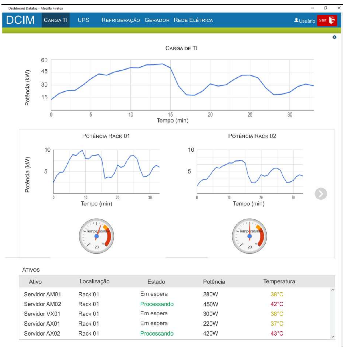
Figura 80 – Painel de monitoramento da carga de TI que será inserido na plataforma DCIM.
