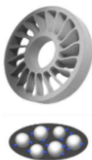
Figura 3 – Peça marrom (acima) e representação da microestrutura (abaixo)
