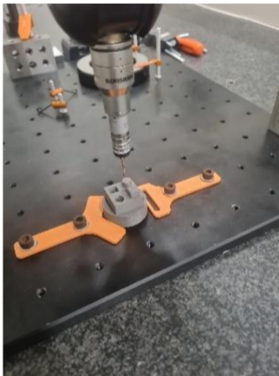
Figura 32 – Coleta das dimensões com a CMM das peças verdes
