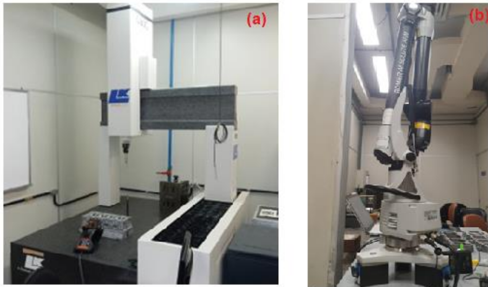
Figura 7 - (a) Máquina tridimensional do IFSC; (b) braço articulado de medição do IFSC.
