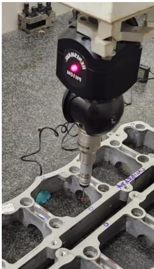
Figura 13 - Peça sendo calibrada no IFSC a 20°C.
