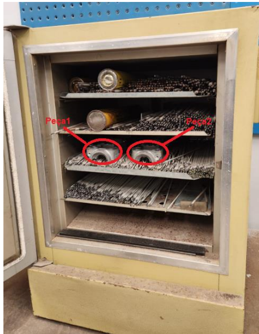
Figura 9 – Peças utilizadas nos experimentos sendo aquecidas na estufa do IFSC.
