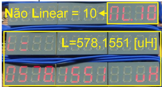
Figura 27 - Resultados para um indutor não linear. NL.10 indica que todas as leituras foram não lineares.
