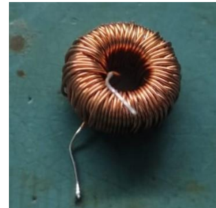
Figura 28 - Indutor utilizado no ensaio, operando com corrente não linear
