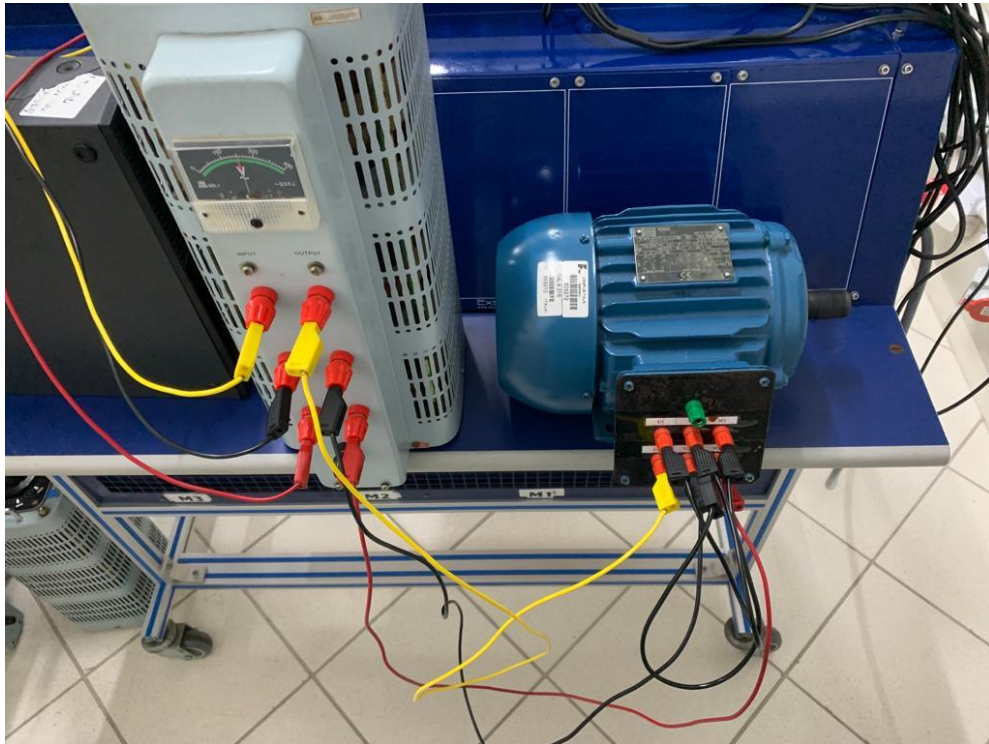
Figura 28 – Motor WEG conectado ao Variac
