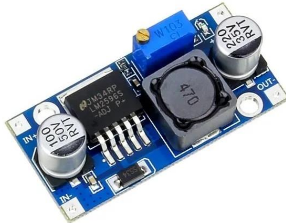
Figura 7 – Conversor de tensão CC-CC step down LM2596
