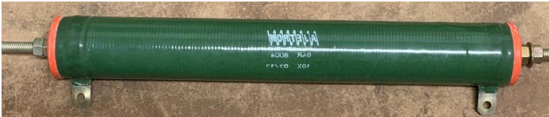
Figura 31 – Resistor de 64 \Omega e 800 W
