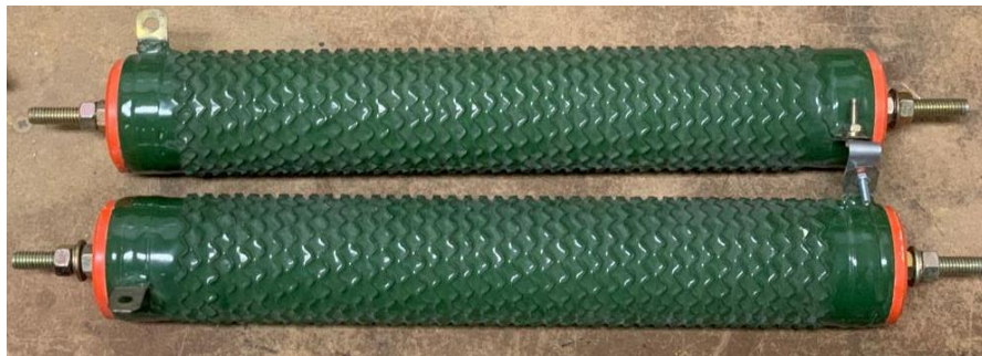
Figura 32 – Resistor equivalente de 40 \Omega e 1500 W
