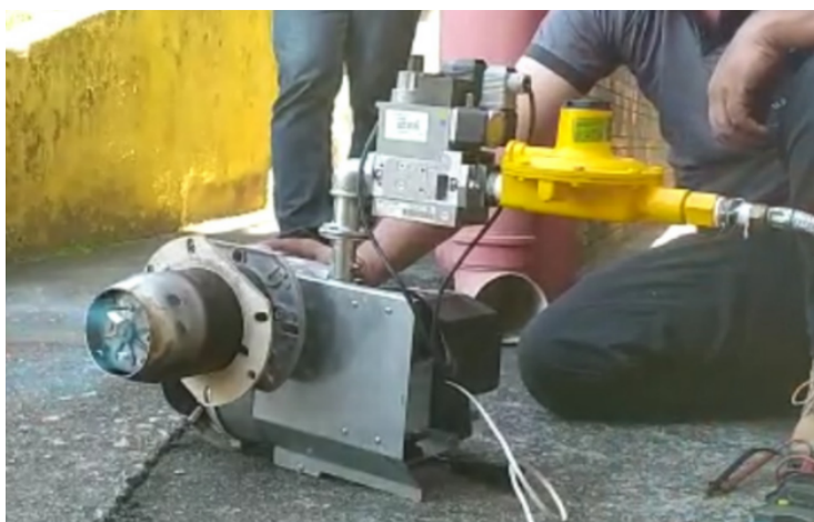
Figura 43 - Aquecedor em funcionamento normal durante testes (com outra válvula)
