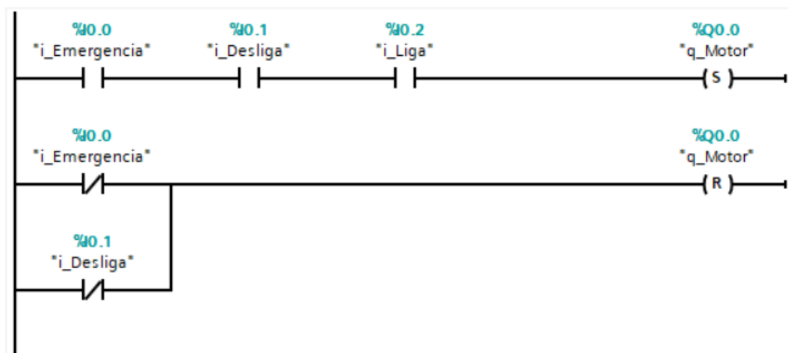
Figura 5 – Exemplo Ladder Acionamento de Motor (Autor, 2025)
