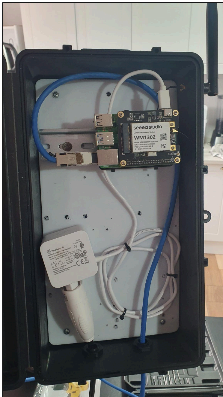
Imagem 17 – Encapsulamento do Raspberry Pi , fonte de alimentação e antena.
