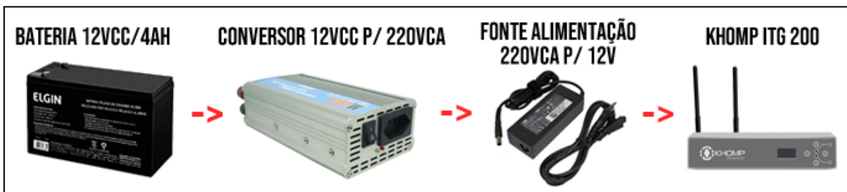
Imagem 47 – Ligação para teste inicial de duração da bateria
