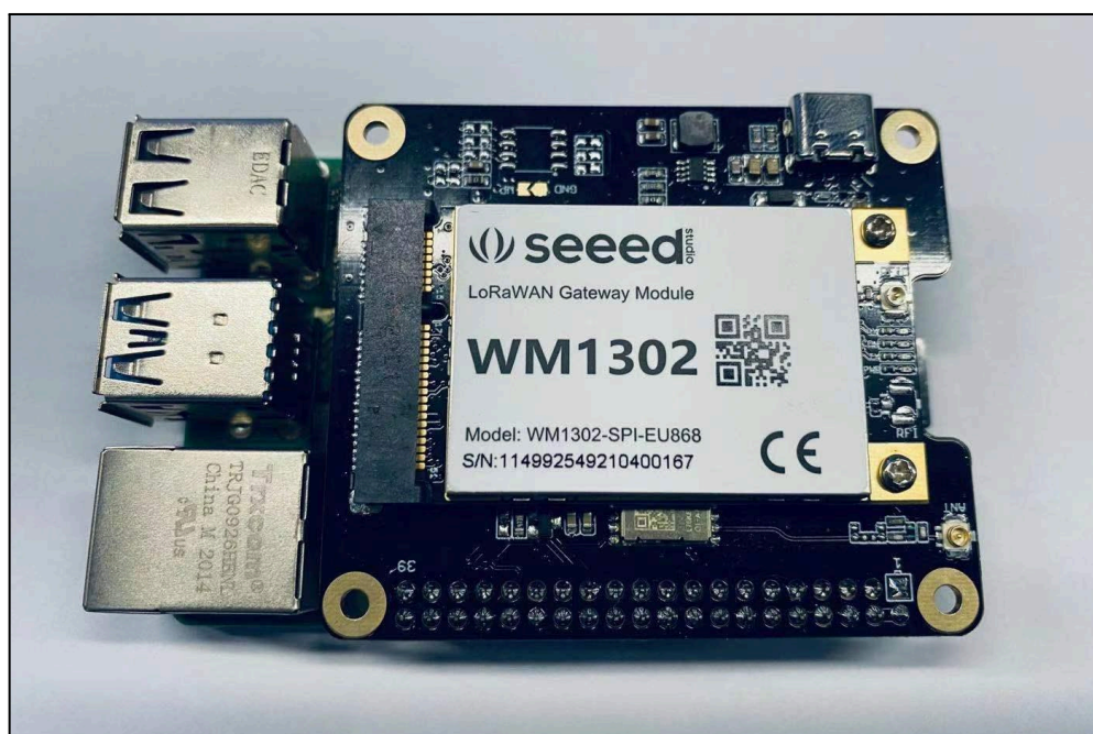
Imagem 5 – Raspberry Pi com o shield WM1302 da Seeed Studio
