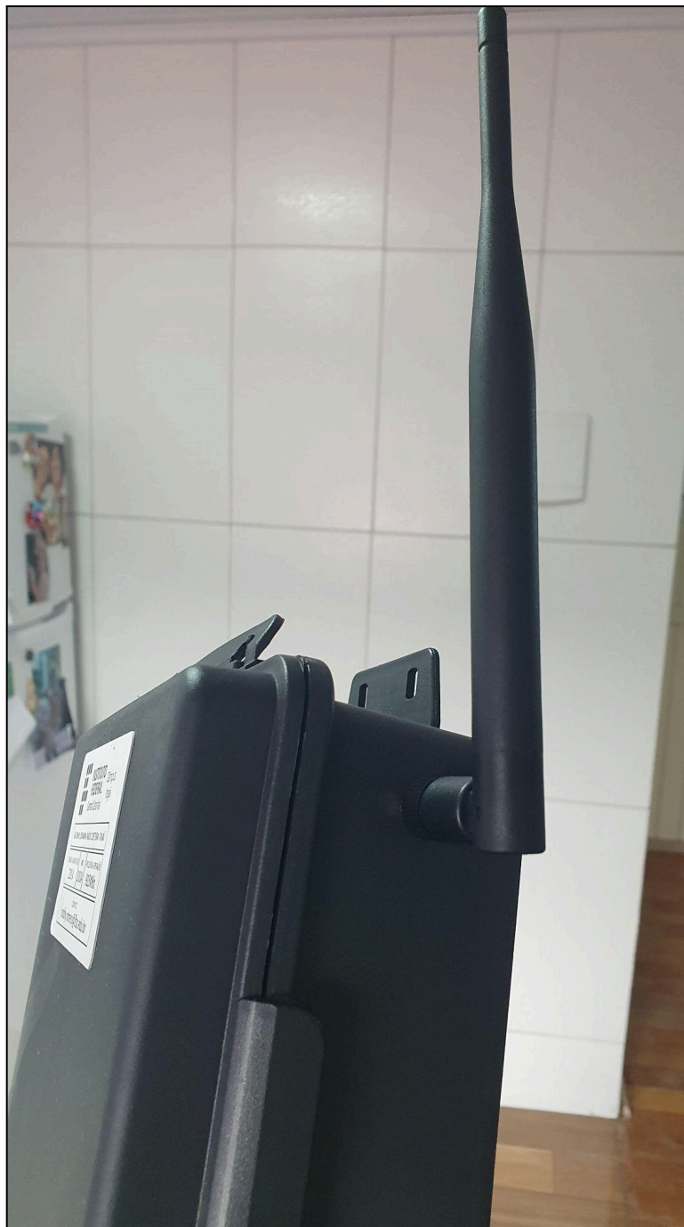
Imagem 18 – Encapsulamento do Raspberry Pi, com antena externa
