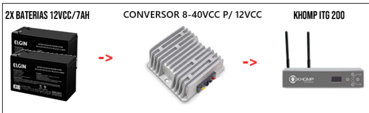
Imagem 50 – Esquema de ligação somente com conversor CC-CC e duas baterias
