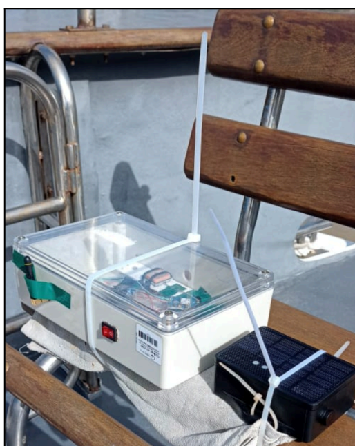
Imagem 61 – Nó-sensor comercial Dragino posicionado com o protótipo de GPS feito com ESP32 deste trabalho
