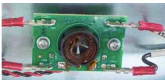
Figura 6 – Resistor shunt espiral para 1 A_{RMS} utilizado no Tektronix PA1000
