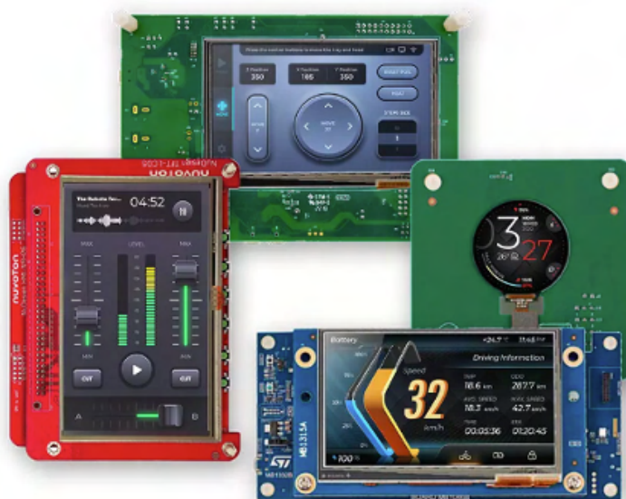
Figura 44 – Exemplos de kits de desenvolvimento com aplicações LVGL
