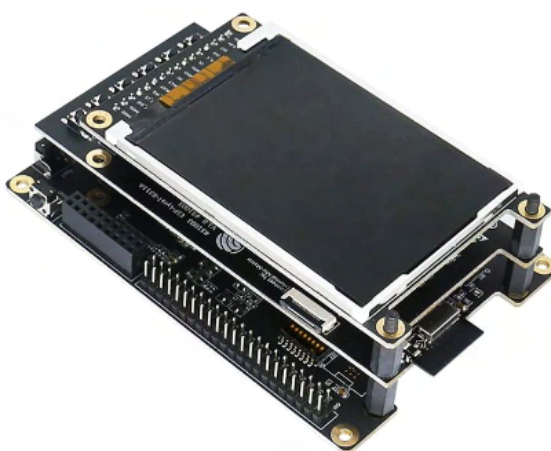
Figura 41 – Kit de desenvolvimento Kaluga-1 V1.3
