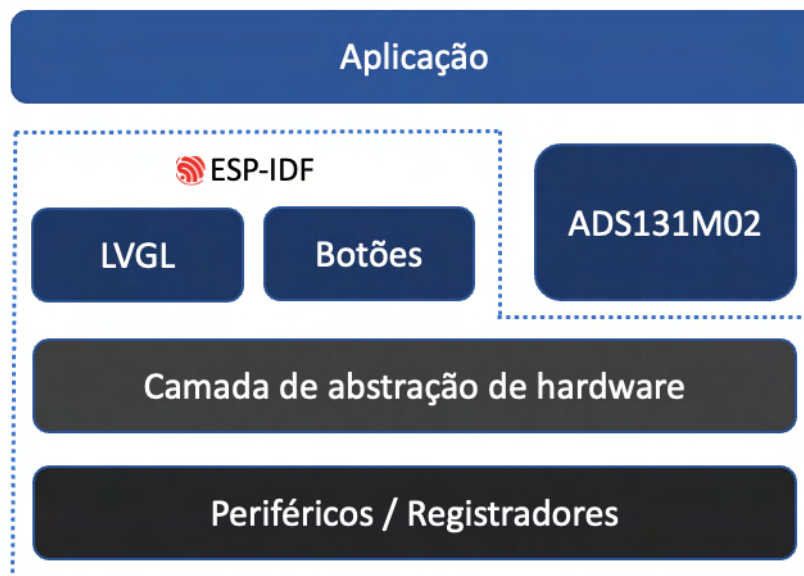
Figura 42 – Camadas propostas para o software embarcado
