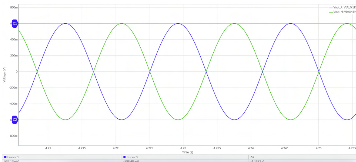
Figura 38 – Resultados de simulação do circuito condicionador do sinal de tensão
