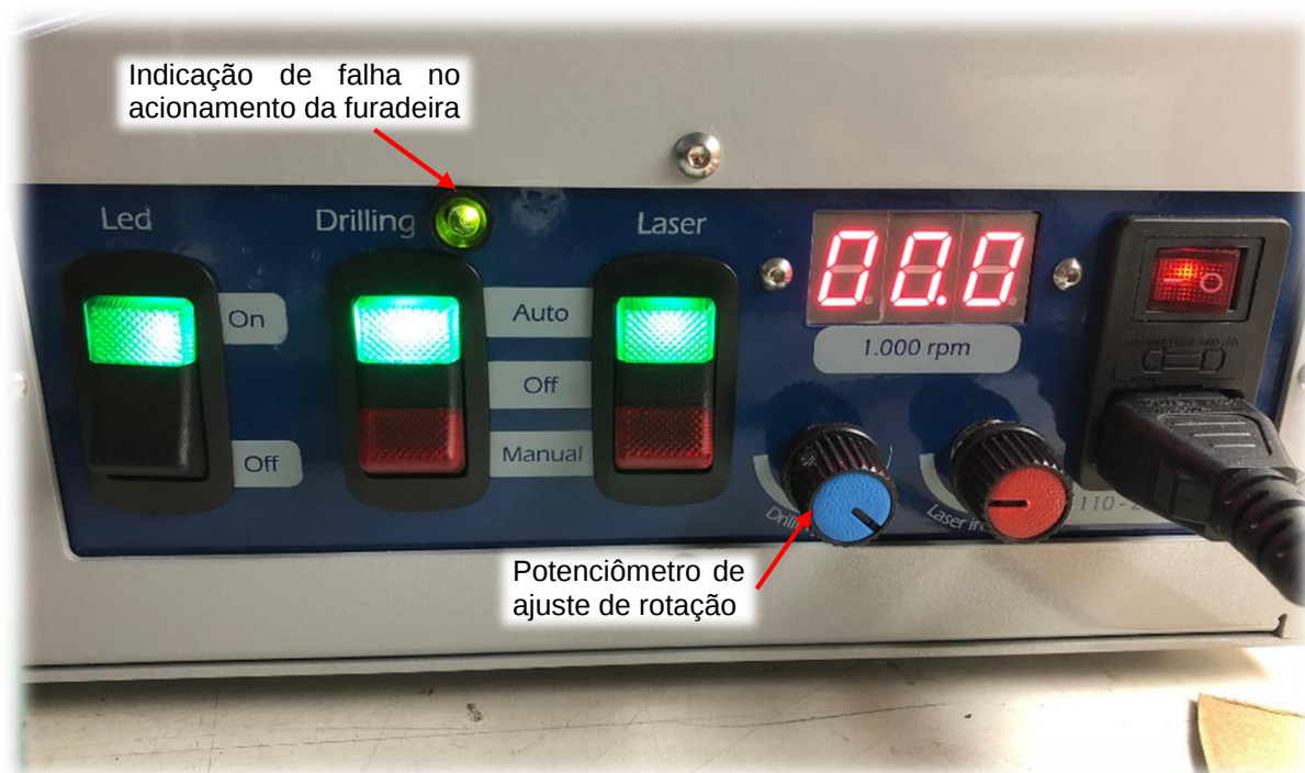
Figura 19 - Painel lateral do módulo de controle potência.
