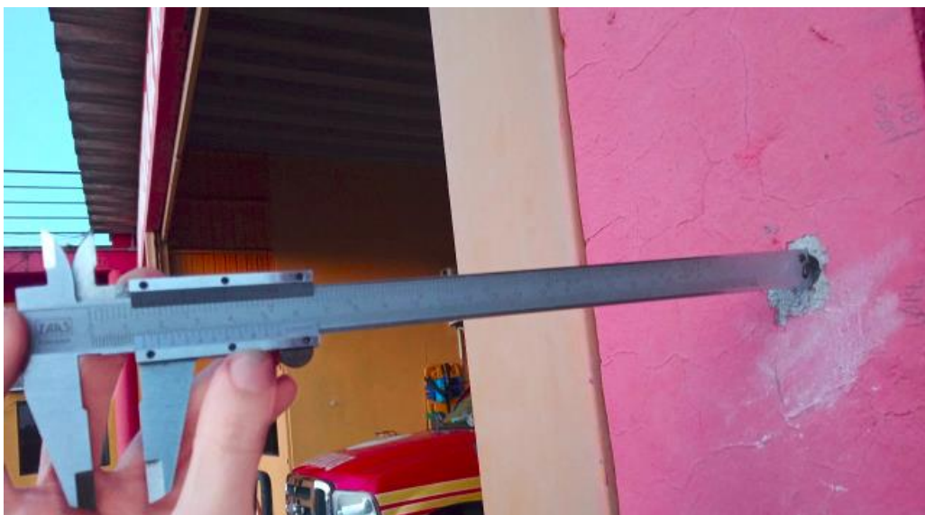
Figura 56 – Medição da profundidade da perfuração do ponto P1, em mm, com um paquímetro
