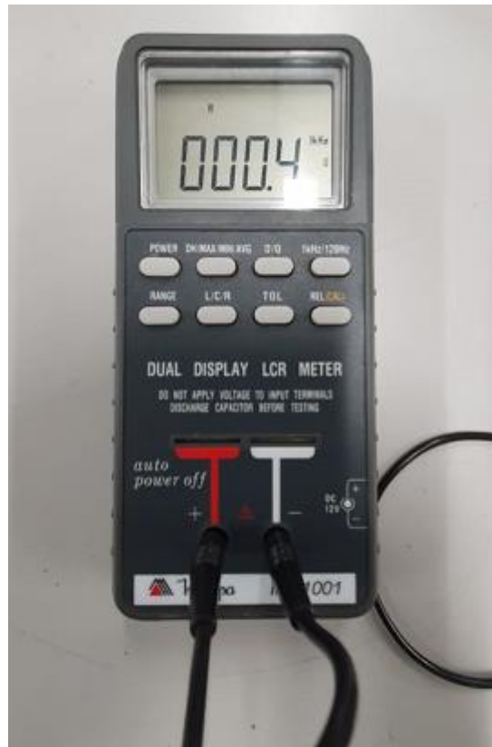
Figura 69 – Medição da resistência dos cabos utilizando medidor de LCR
