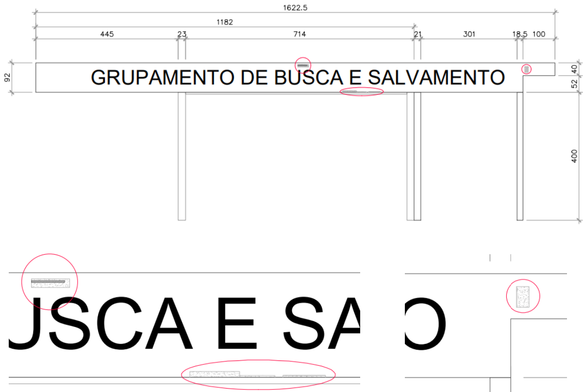
Figura 45 – Croqui dos elementos estruturais analisados da fachada noroeste com indicação de fissurações e exposição de armaduras (vista frontal)
