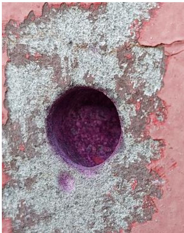
Figura 82 – Perfuração P2 após a ação do reagente fenolftaleína
