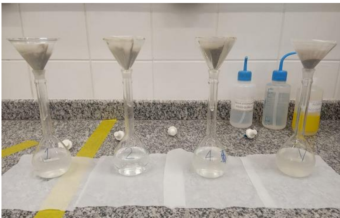
Figura 61 – Filtração das amostras
