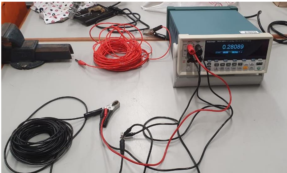
Figura 73 – Leitura da resistência do cabo preto utilizando um multímetro de bancada
