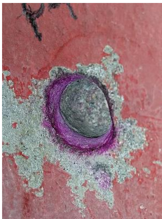
Figura 83 – Perfuração P4 após a ação do reagente fenolftaleína
