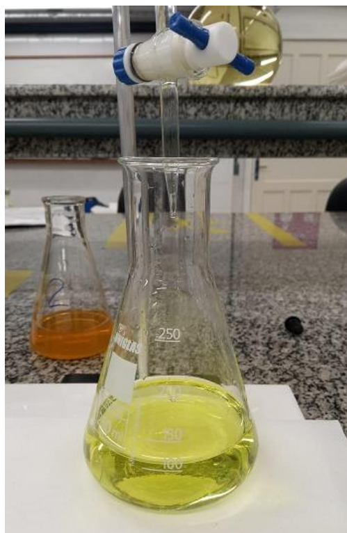
Figura 65 – Erlenmeyer com amostra contendo solução indicadora de \text{K}_2\text{CrO}_4
