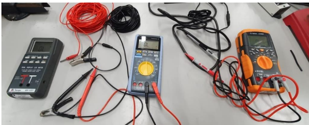
Figura 68 – Medição da resistência dos cabos utilizando medidor de LCR e multímetros
