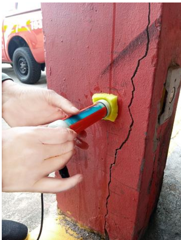
Figura 77 – Realização do teste do eletrodo
