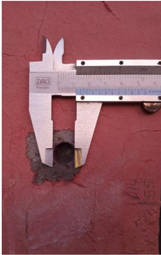
Figura 55 – Medição do diâmetro de uma das perfurações, em mm, com um paquímetro
