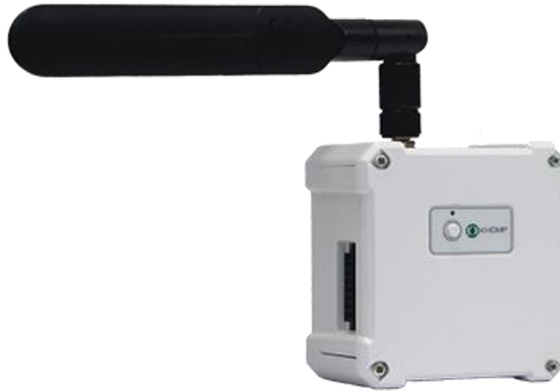
Imagem 5 – Ilustração do NIT 21LI instalado na estufa para monitoramento de temperatura d'água dos tanques
