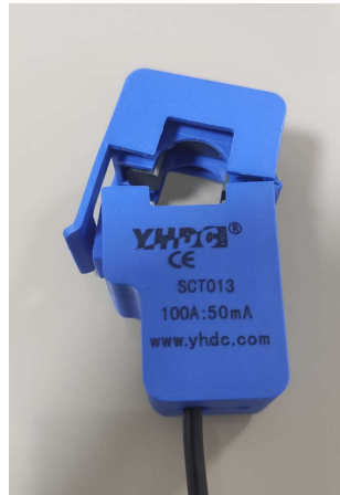
Figura 35 – Transformador de corrente utilizado no projeto
