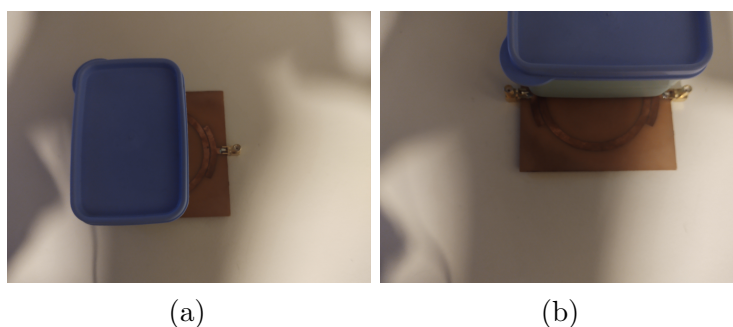
Figura 34 – Posições perpendicular (a) e paralela (b) à LT para inserir o recipiente na superfície do sensor.
