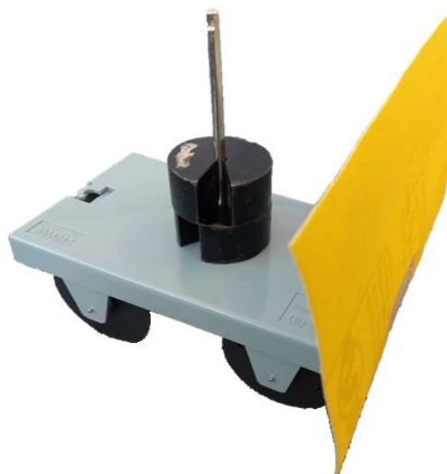
Figura 14 – Carrinho de testes com pesos e anteparo.
