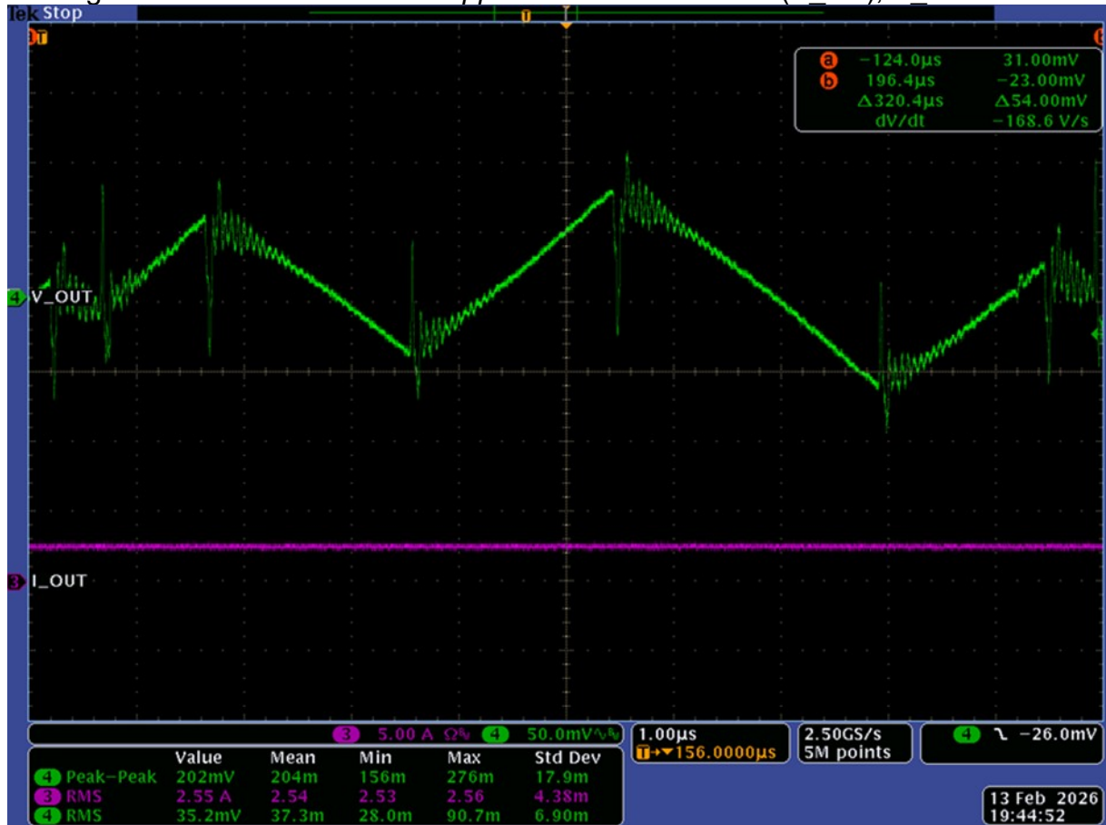
Figura 26: Forma de onda do ripple de tensão na saída ( V_{out} ), V_{in} = 30\text{ V} .
