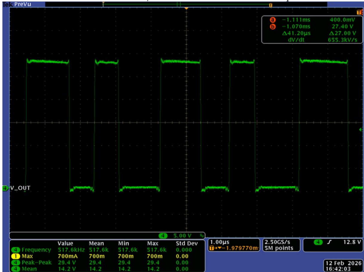
Figura 20: Forma de onda no nó de comutação do conversor buck síncrono, evidenciando f \approx 517,6 kHz e elevada dv/dt nas transições.
