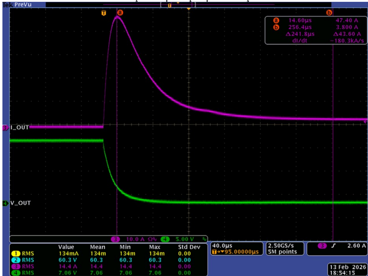
Figura 40: Resposta do conversor buck síncrono a curto-circuito na saída, evidenciando atuação da proteção por limitação de corrente.
