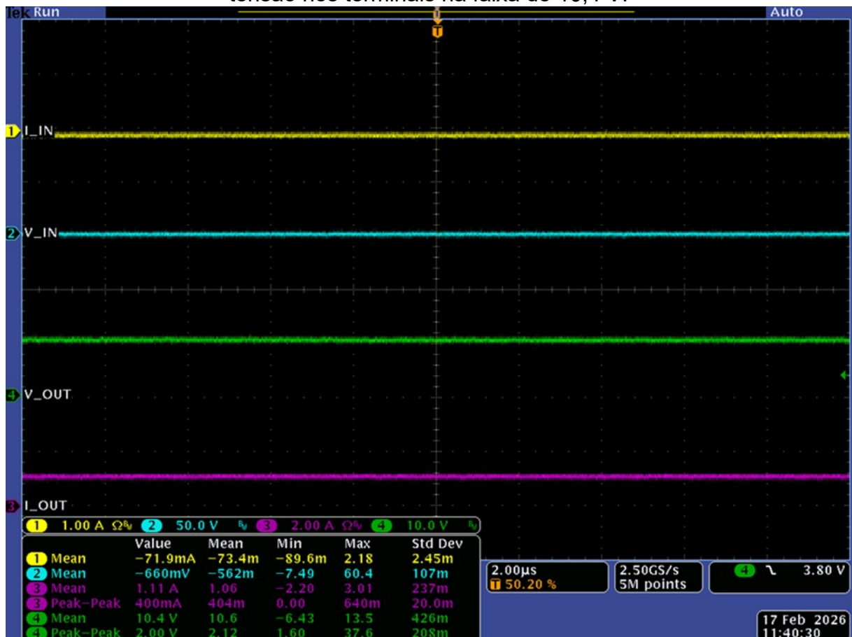
Figura 29: Condição inicial do ensaio: bateria conectada a carga resistiva, indicando tensão nos terminais na faixa de 10,4 V.
