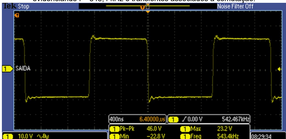
Figura 19: Forma de onda no nó de comutação do conversor buck assíncrono, evidenciando f \approx 543,4 kHz e transientes associados à comutação.
