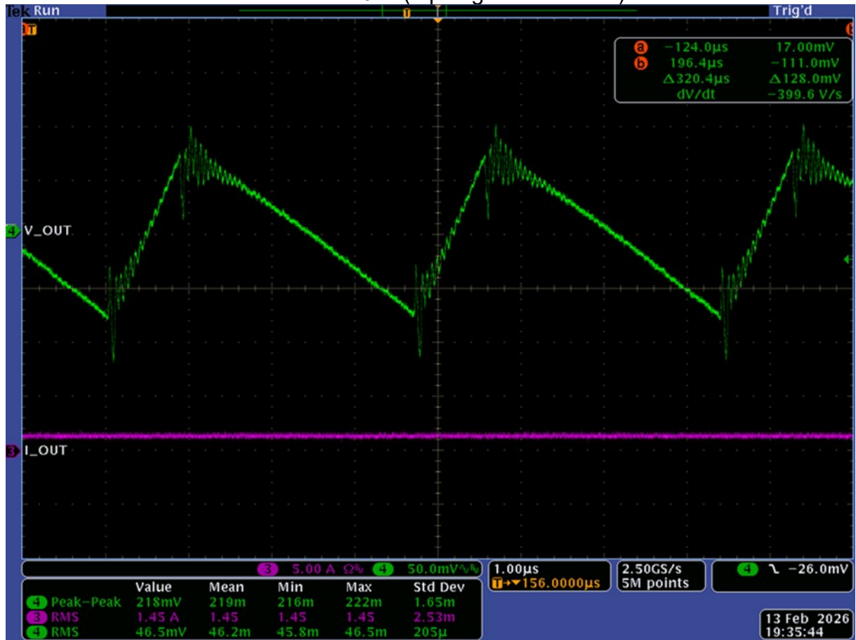
Figura 25: Forma de onda do ripple de tensão na saída ( V_{out} ), V_{in} = 60\text{ V} , carga resistiva de 10\ \Omega (topologia assíncrona).
