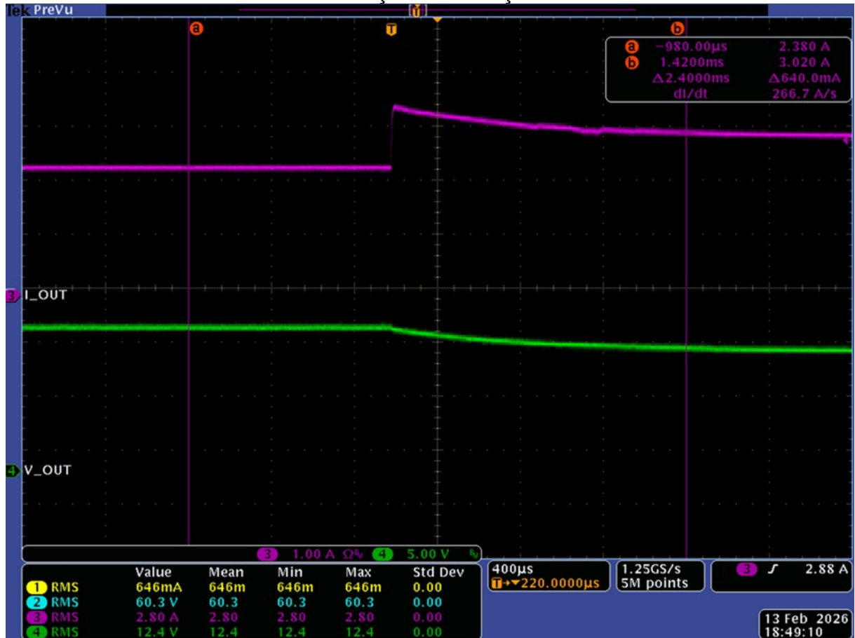
Figura 39: Resposta do conversor buck síncrono à variação brusca de carga, evidenciando atuação da limitação de corrente.
