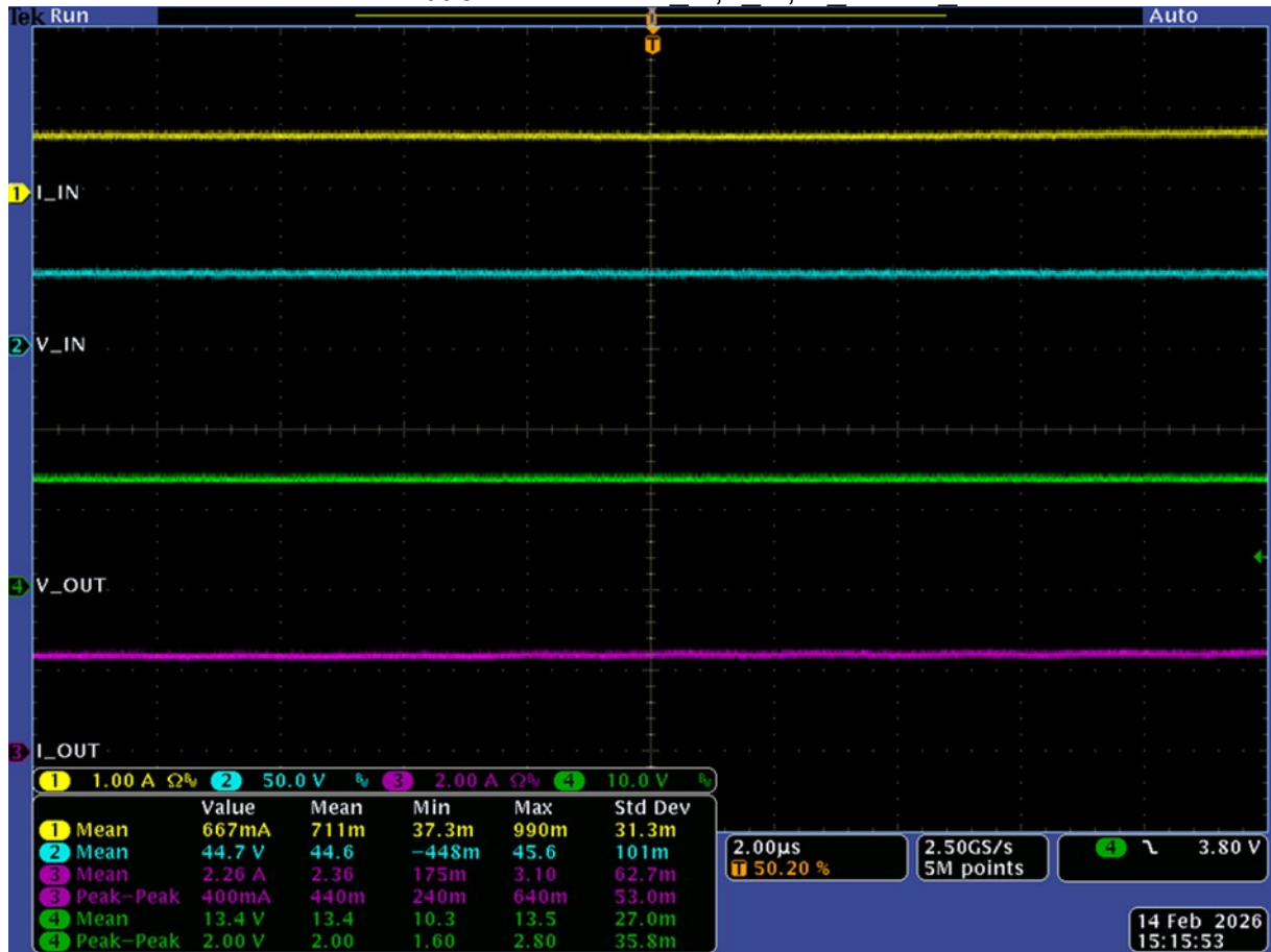
Figura 42: Captura representativa do osciloscópio durante o ensaio de carga com o conversor buck síncrono: V_{in} , I_{in} , V_{out} e I_{out} .
