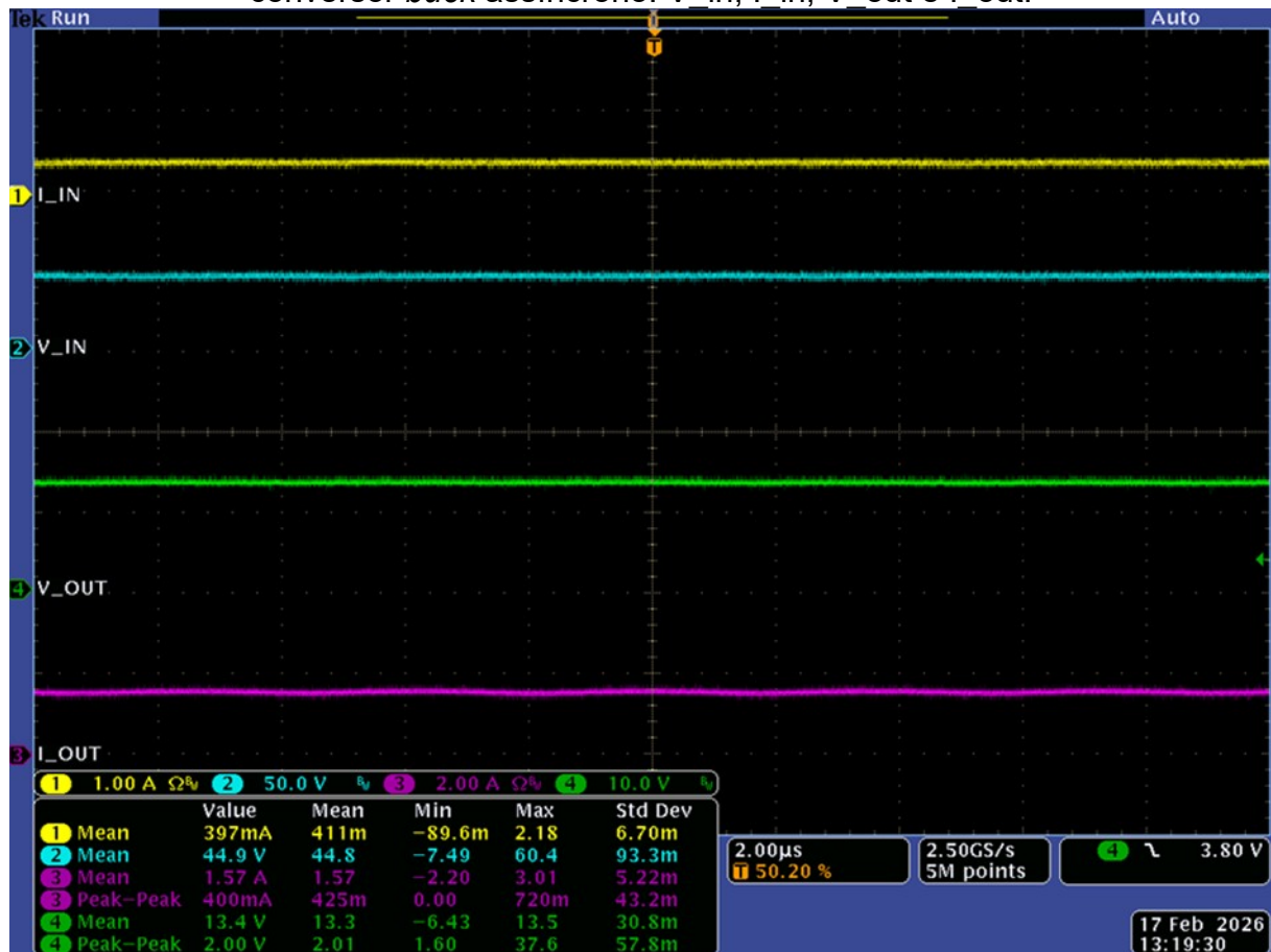
Figura 30: Captura representativa do osciloscópio durante o ensaio de carga com o conversor buck assíncrono: V_{in} , I_{in} , V_{out} e I_{out} .
