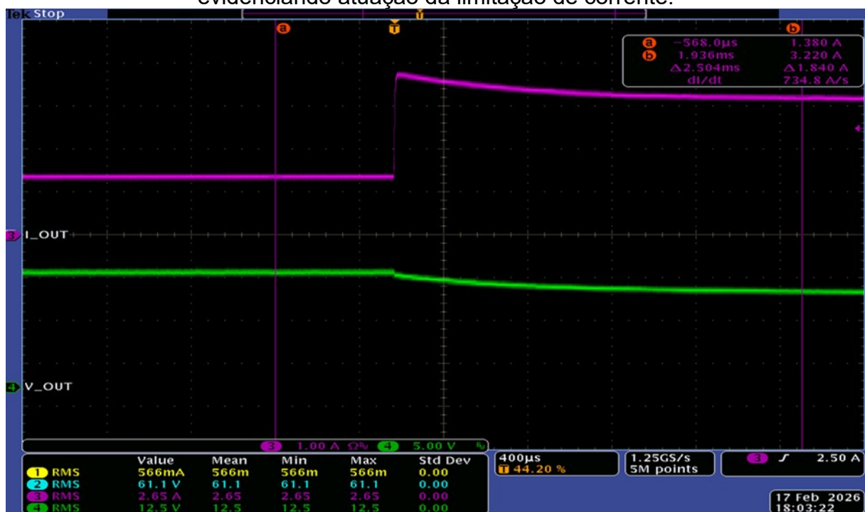
Figura 27: Resposta do conversor buck assíncrono à variação brusca de carga, evidenciando atuação da limitação de corrente.
