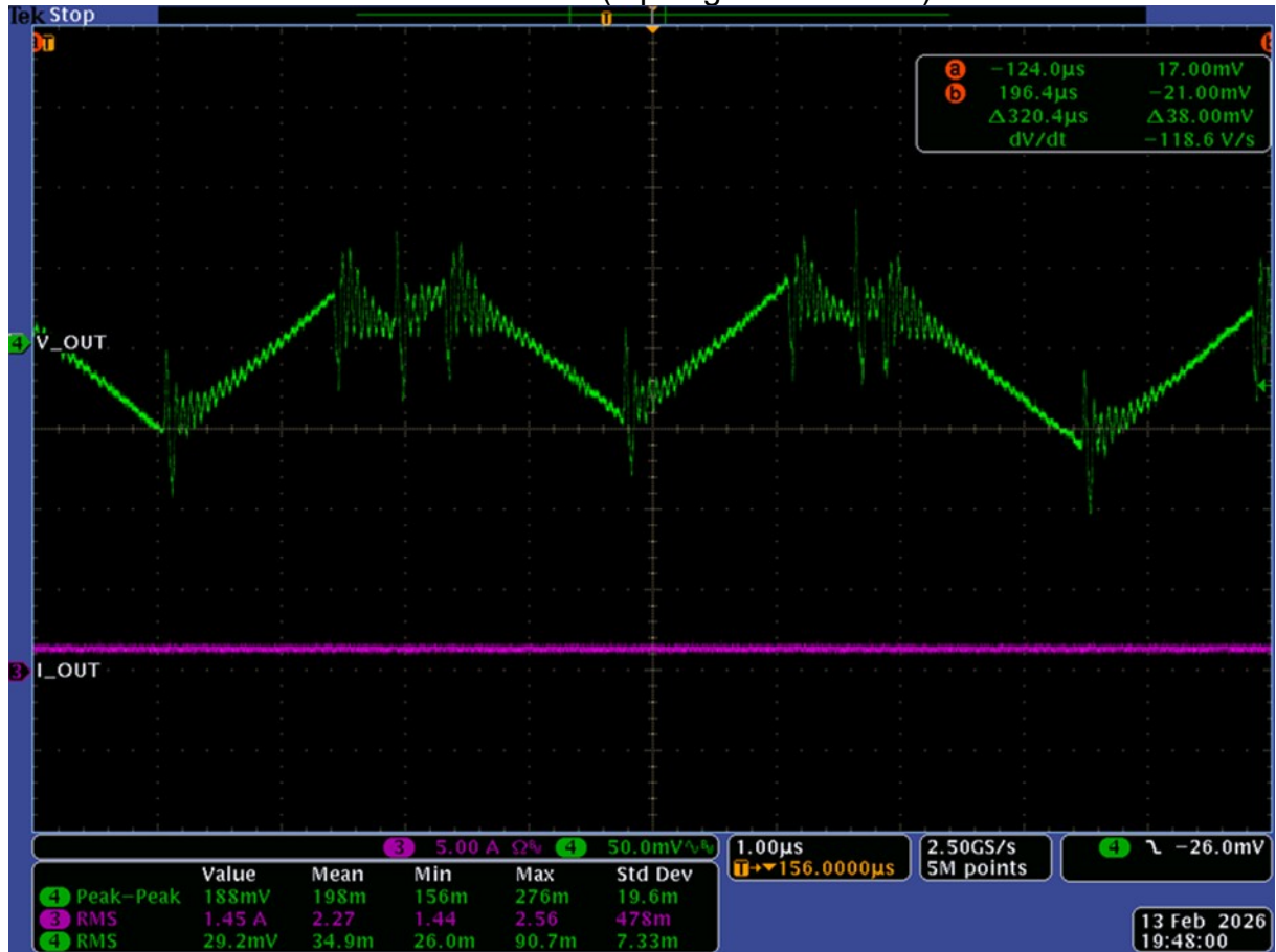
Figura 24: Forma de onda do ripple de tensão na saída ( V_{out} ), V_{in} = 30\text{ V} , carga resistiva de 10\ \Omega (topologia assíncrona).
