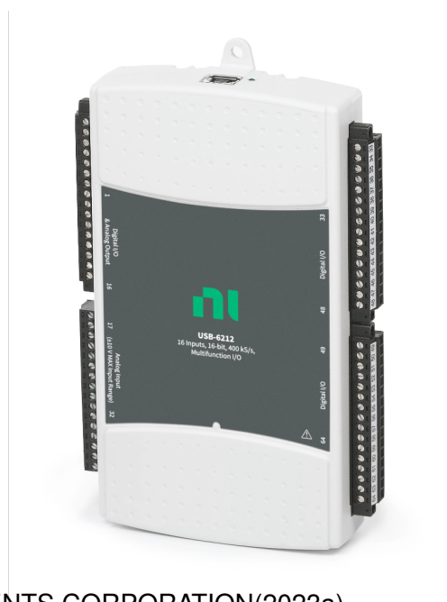
Figura 3 – Dispositivo DAQ USB-6212 da fabricante National Instruments
