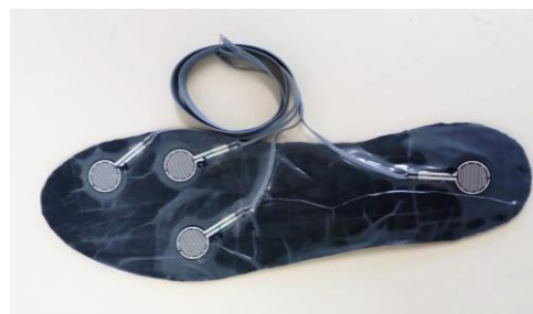
Fig. 8. Palmilha com solado de borracha confeccionada em laboratório com sensores posicionados.
