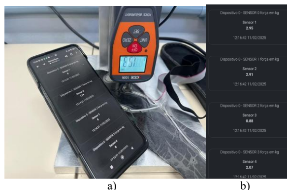
Fig. 12. Integração com plataforma de banco de dados. a) Envio de um único sensor. b) Envio simultâneo de dados.
