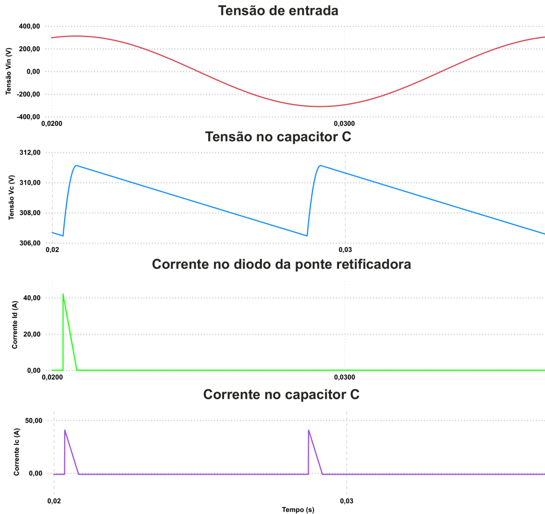
Figura 19 – Resultados da simulação da Ponte Retificadora
