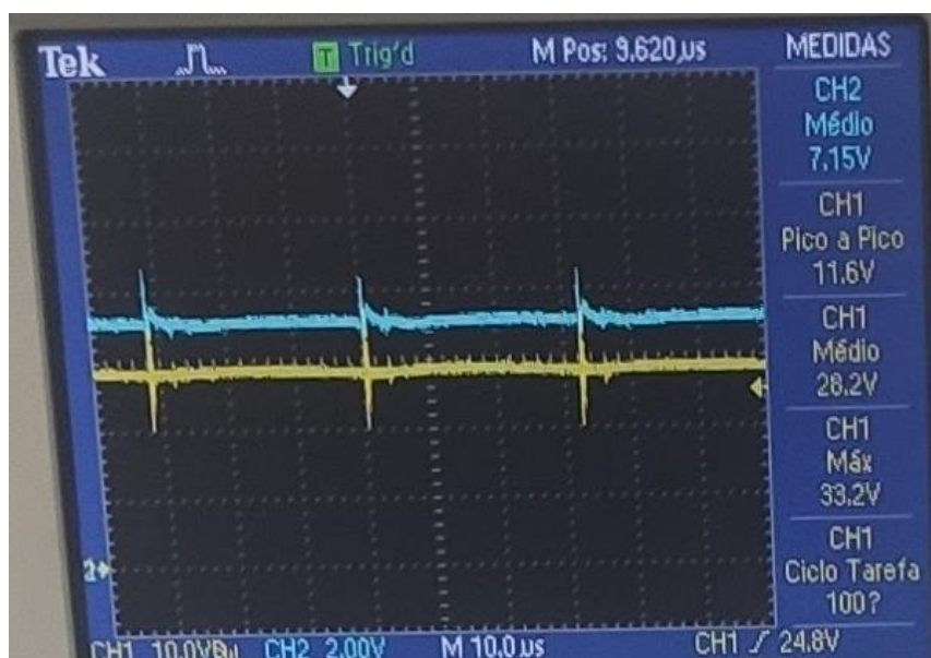
Figura 32 - Curvas de tensão e corrente de saída do emulador
