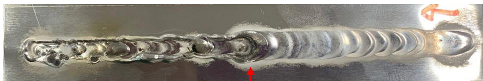
Figura 14 – Cordão de solda com v = 7,5 mm/s
