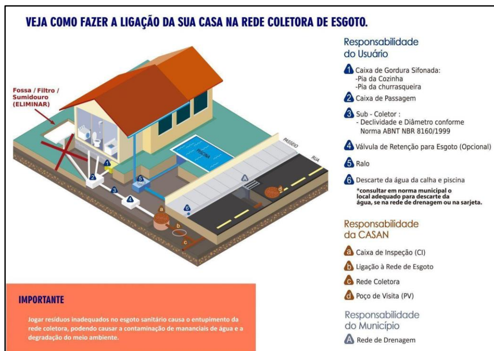
Figura 1 - Ligação domiciliar à rede de esgoto.
