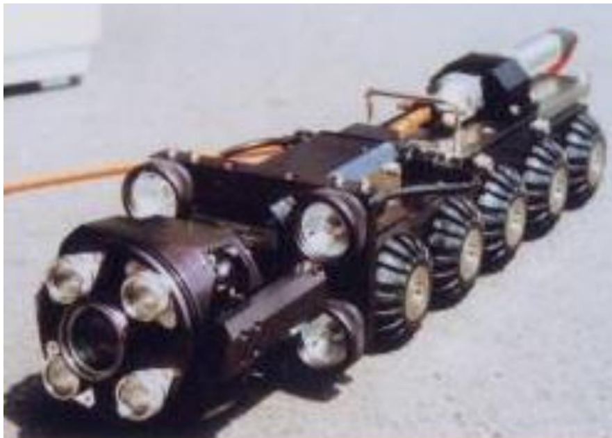
Figura 7 - Robô com câmera para inspeção interna de tubulações de esgoto.
