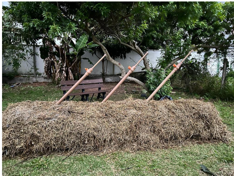
Figura 24 - Câmara de amostragem para medição de GEE inseridas na leira de compostagem
