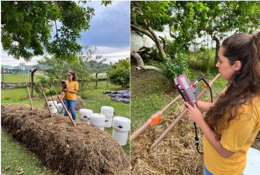
Figura 25 - Medição de GEE na leira de compostagem utilizando o analisador portátil Optima 7
