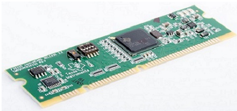
Figura 11 – TMDSCNCD28335 controlCard com TMS320F28335 utilizado neste trabalho.
