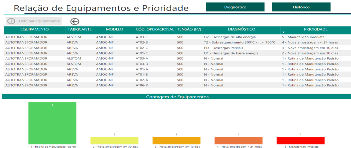
Fig. 6(d) – Indicador de diagnóstico normalizado com nível de prioridade
