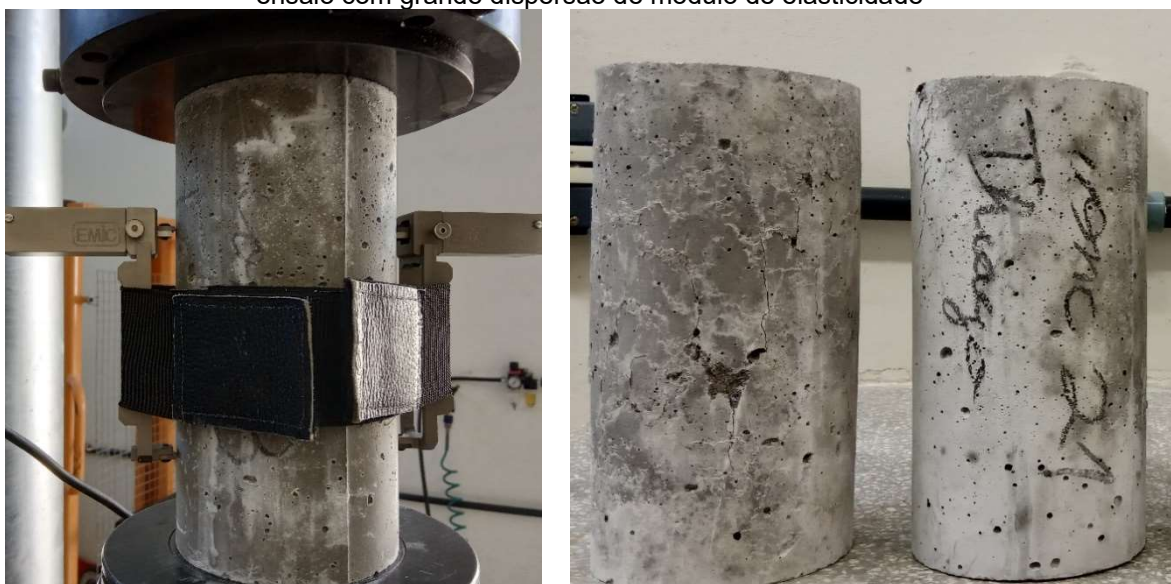
Figura 23 a) Corpo de prova com bolhas superficiais sendo ensaiado; b) Corpos de prova após ensaio com grande dispersão de módulo de elasticidade
