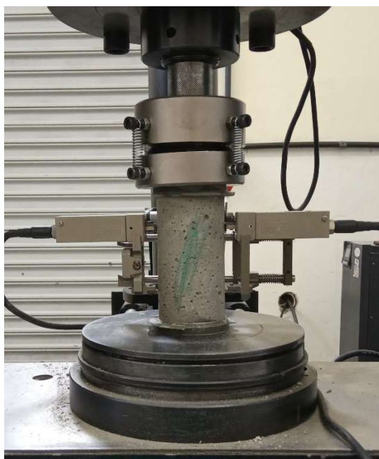
Figura 17: Exemplo de ensaio de Módulo de Elasticidade com medidores clip gages em corpo de prova de argamassa
