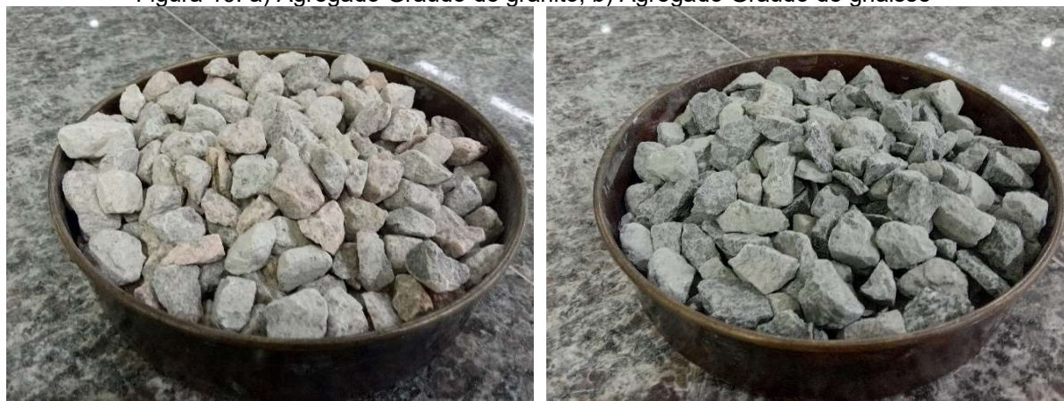
Figura 19: a) Agregado Graúdo de granito; b) Agregado Graúdo de gnaisse
