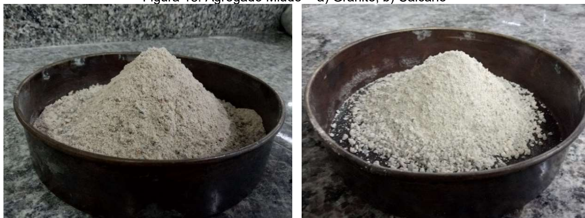
Figura 18: Agregado Miúdo - a) Granito; b) Calcário
