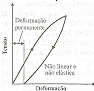
Figura 4: Diagrama tensão-deformação específica típico do concreto
