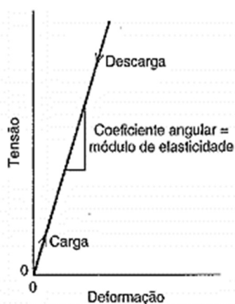
Figura 2: Gráfico tensão-deformação demonstrando a deformação elástica linear
