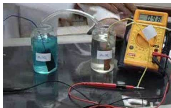
Fotos 2: Montagem da Pilha de Daniell e medição da voltagem obtida
