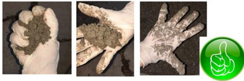
Figura 11 - Ajuste da consistência do concreto permeável: (a) comprimindo na luva, (b) partículas cobertas de pasta e (c) aspecto brilhoso
