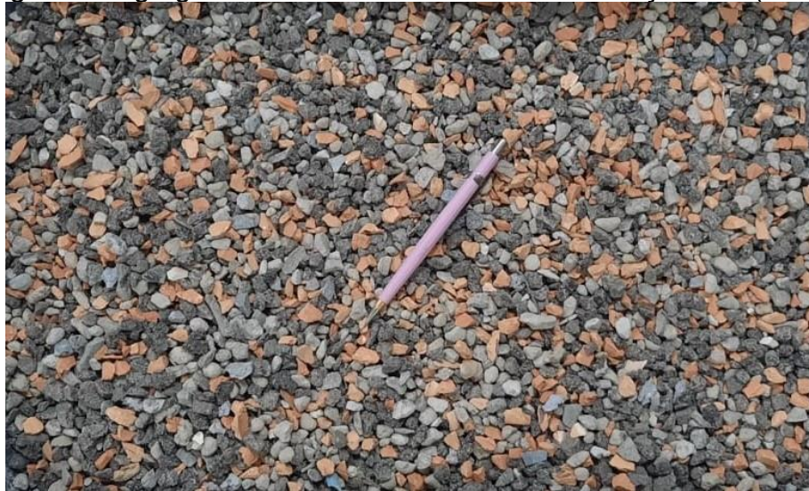
Figura 5 - Agregado reciclado de resíduo da construção civil (RCC)
