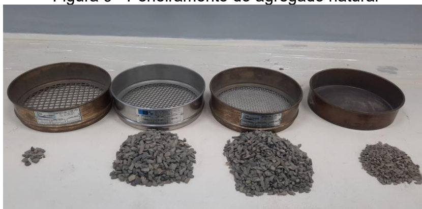
Figura 9 - Peneiramento do agregado natural
