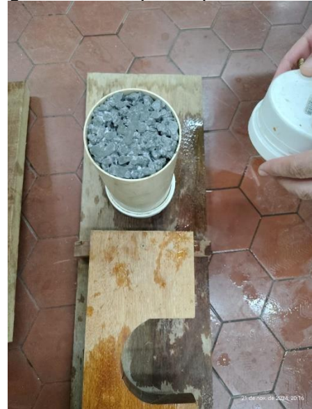
Figura 13 - Permeômetro de carga constante Figura 14 - Corpo de prova cilíndrico
