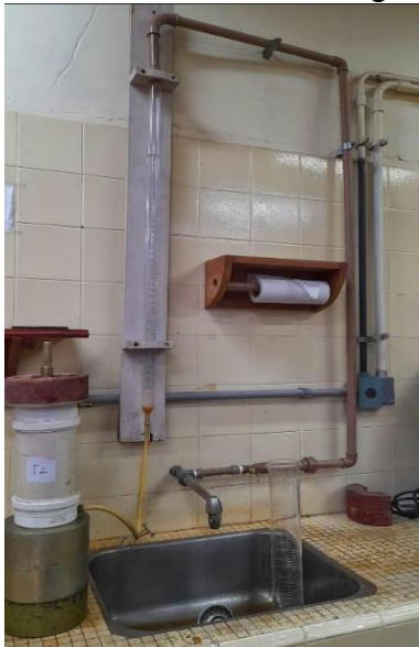
Figura 13 - Permeômetro de carga constante Figura 14 - Corpo de prova cilíndrico
