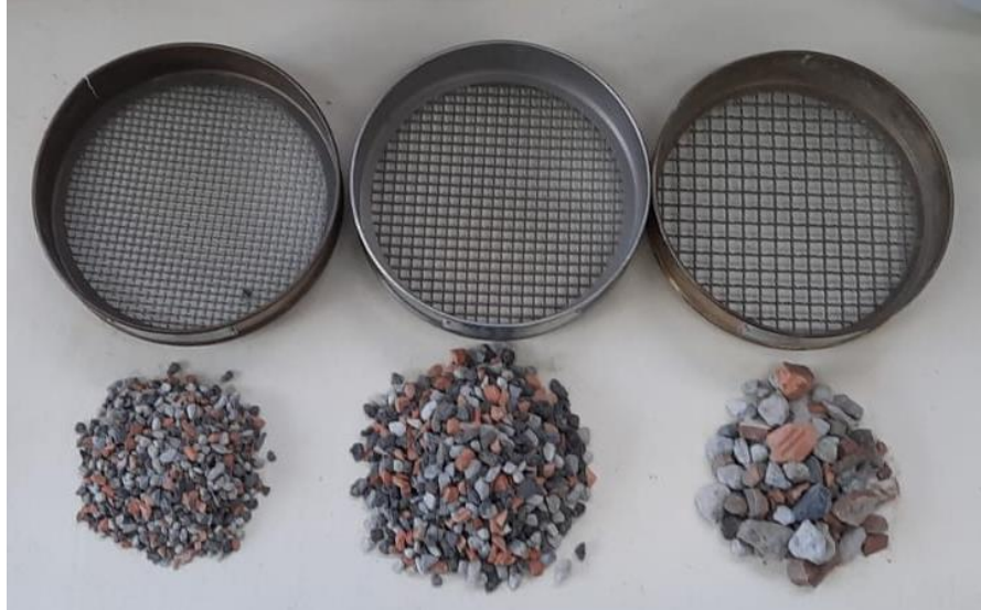
Figura 10 - Peneiramento do resíduo da construção civil (RCC)
