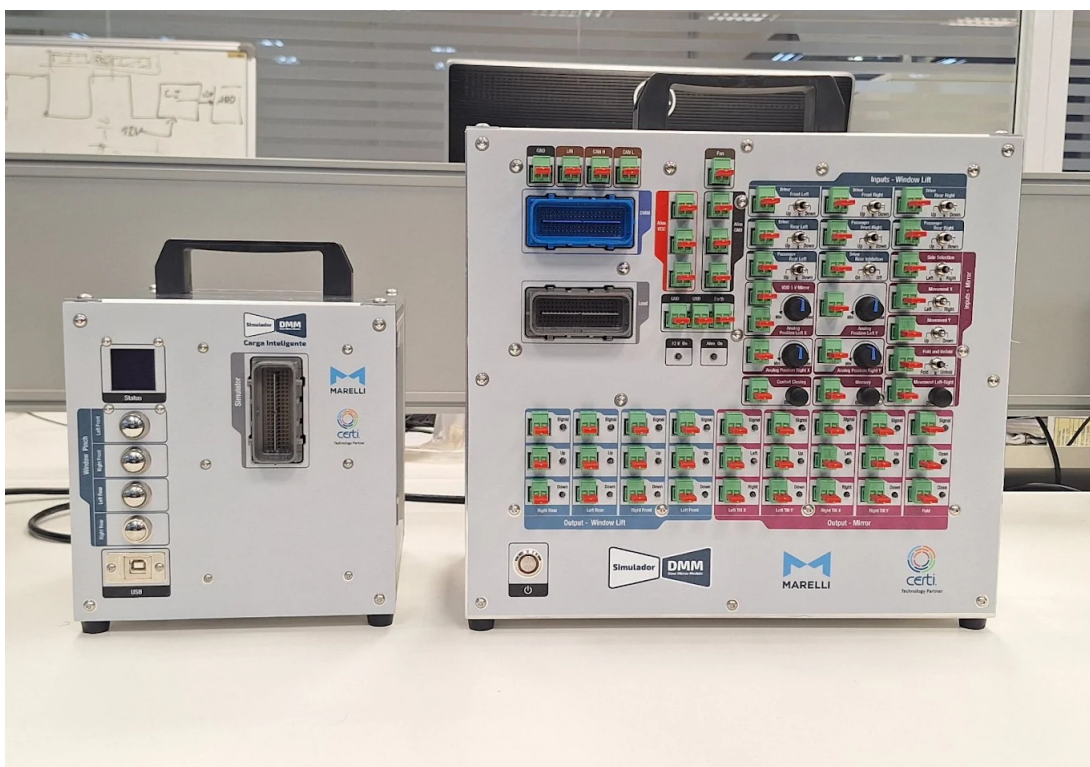
Figura 20 – Protótipo e sistema de acesso à sinais
