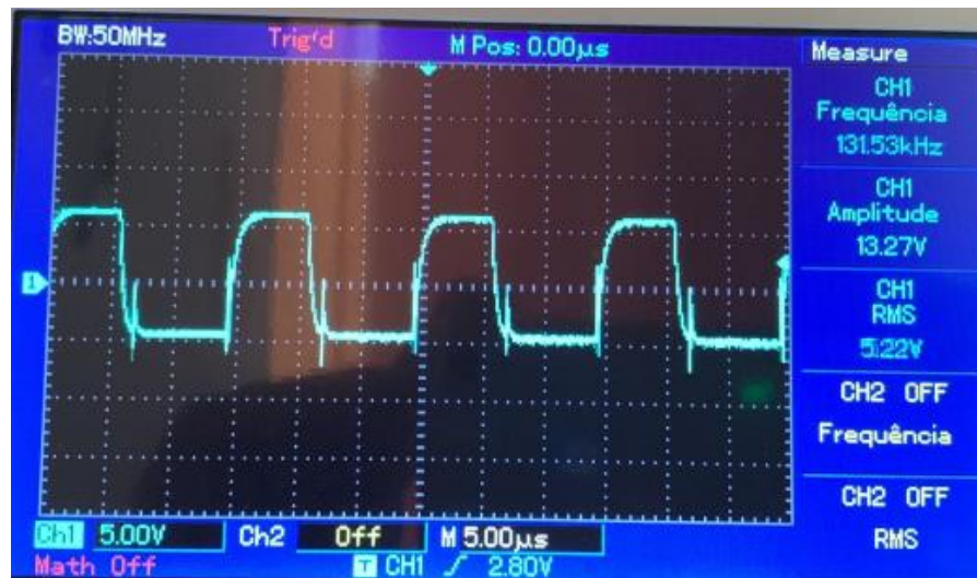
Figura 34 – Tensão no gate do mosfet com carga
