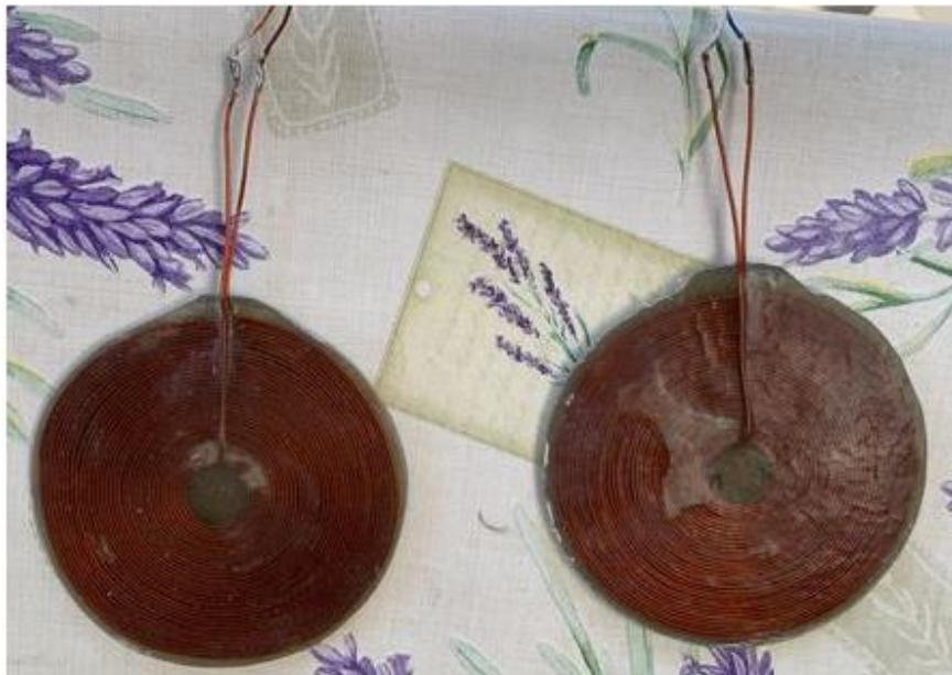
Figura 13 – Bobina plana utilizada no protótipo
