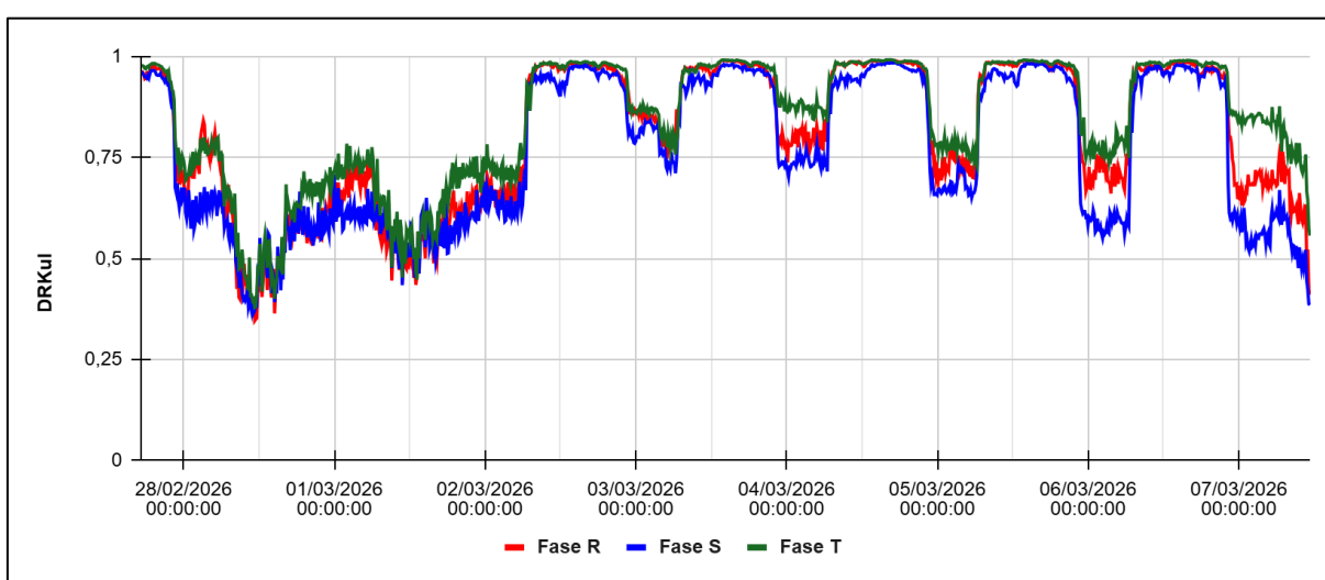
Figura 41 – DRKul durante análise para o transformador 4 (UL 1561)
