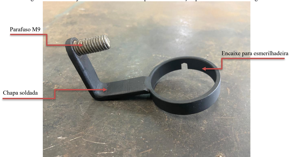
Figura 19 – Subconjunto 1.1 - Encaixe do dispositivo de afiação para esmerilhadeira angular
