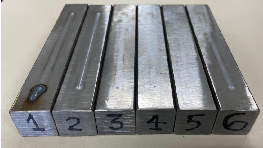
Figura 35 - Corpos de prova soldados com eletrodos de \theta = (1) 30°; (2) 60°; (3) 90°; (4) 120°; (5) 150°; (6) 180°.
