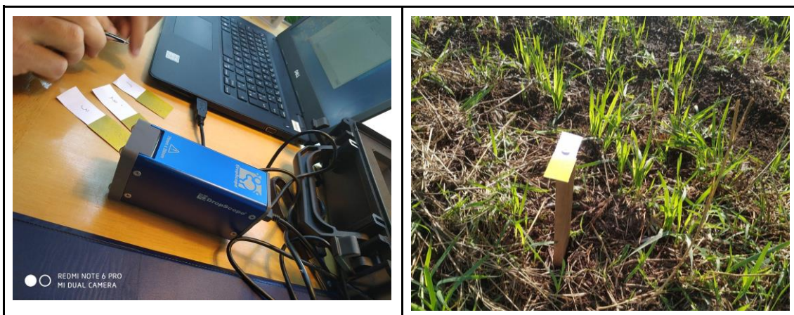
Figura 3: DropScope para a realização da leitura dos papéis hidrossensíveis. Fonte: Autores
