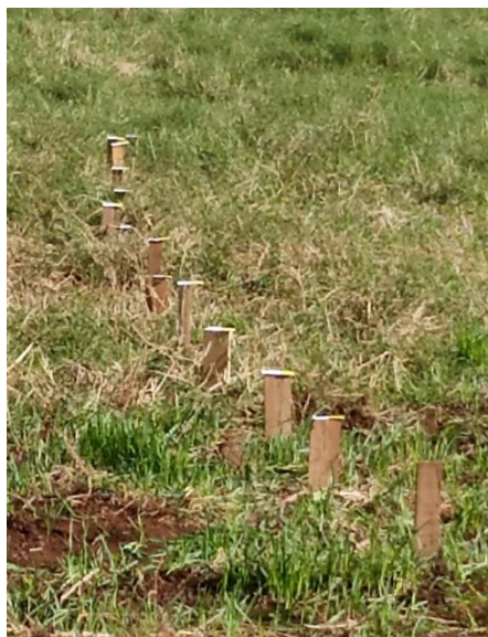
Apêndice A: Estacas posicionadas a cada metro.
