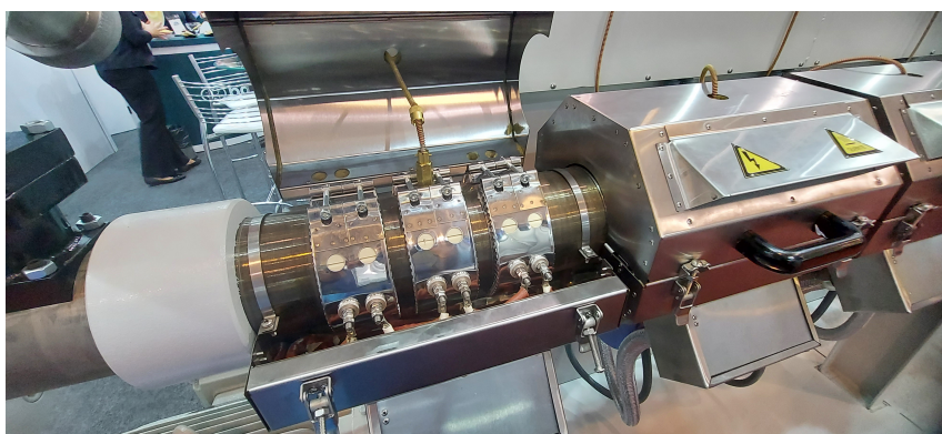
Figura 21 – Resistência elétrica de aquecimento instalada em máquinas extrusoras
